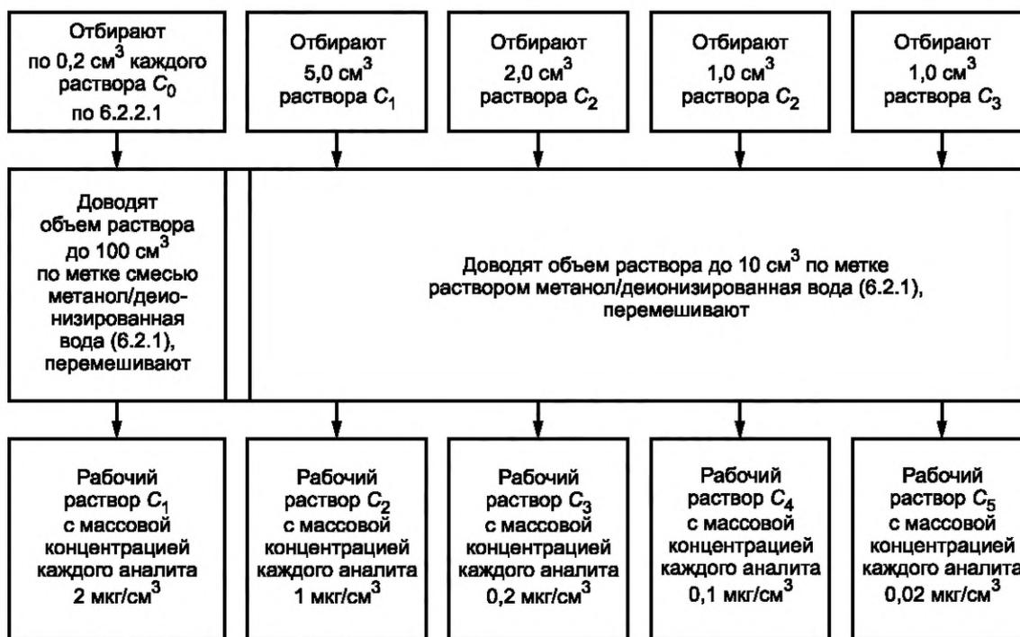
Рисунок 1 — Приготовление рабочих растворов  $C_1$ —  $C_5$
