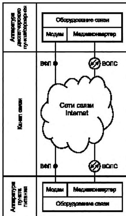
ВФЛ — выделенные физические линии; ВОЛС — волоконно-оптическая линия связи
