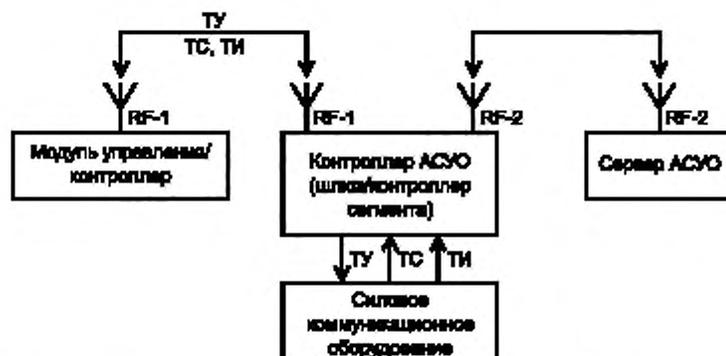
АСУО — автоматизированная система управления освещением; RF-1 и RF-2 — беспроводные радиоканалы, TI — телеизмерение; TC — телесигнализация; TU — телеуправление
