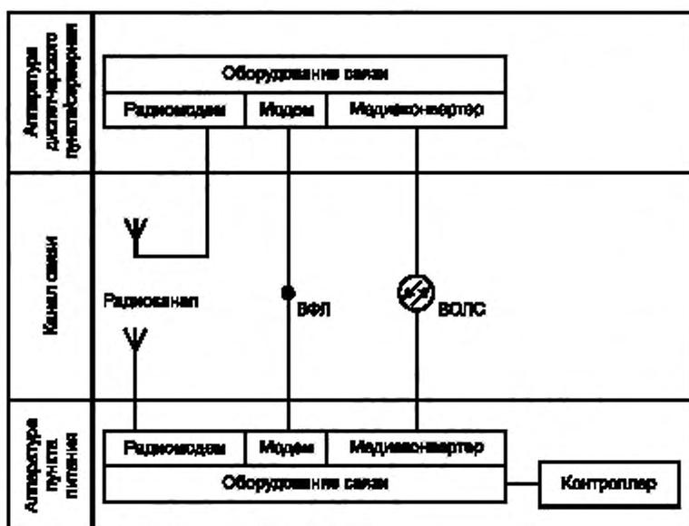
ВФЛ — выделенные физические линии. ВОЛС — волоконно-оптическая линия связи
