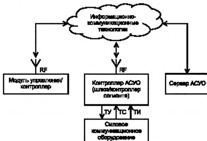
АСУО — автоматизированная система управления освещением, RF — беспроводные радиоканалы; TI — телеизмерение; TC — телесигнализация; TU — телеуправление
