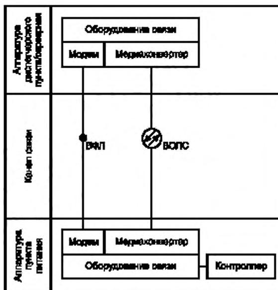
ВЛ — выделенные физические линии; ВОЛС — волоконно-оптическая линия связи
