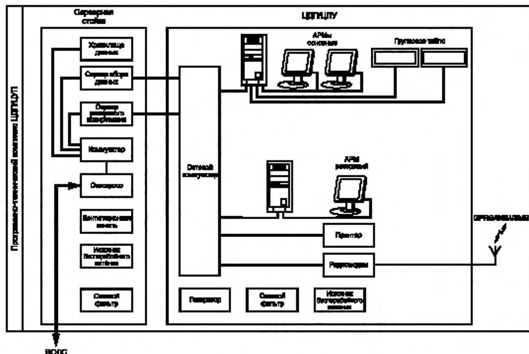
ЦДП — центральный диспетчерский пункт. ЦУП — центр управления производством; АРМ — автоматизированное рабочее место; ВОЛС — волоконно-оптическая линия связи; GPRS/GSM/SMS — виды связи
