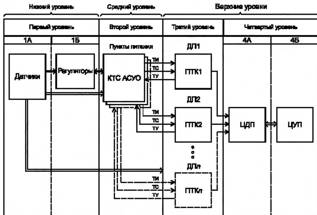
АСУО — автоматизированная система управления освещением; ДП — диспетчерский пункт, КТС — комплекс технических средств, ПТК — программно-технический комплекс, ТИ — телеизмерение; ТС — телесигнализация, ТУ — телеуправление; ЦДП — центральный диспетчерский пункт; ЦУП — центр управления производством
