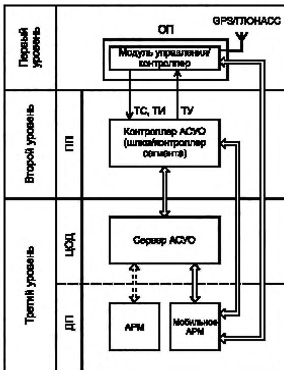
ДП — диспетчерский пункт; ПП — пункт питания; ЦОД — центр обработки данных; АСУО — автоматизированная система управления освещением; АРМ — автоматизированное рабочее место; GPS/ГЛОНАСС — навигационные системы; ТИ — телеизмерение. ТС — телесигнализация. ТУ — телеуправление
