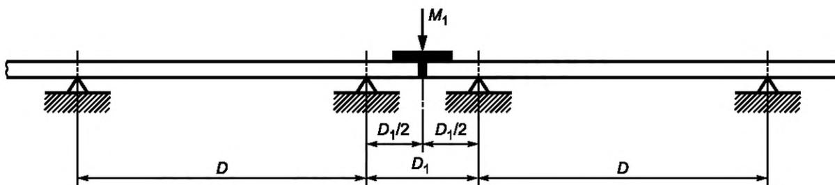
Рисунок 102 — Испытание соединения механической нагрузкой
