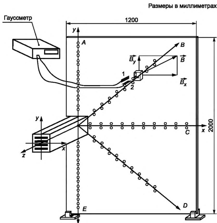
Рисунок EE.1 — Устройство для измерения магнитного поля
