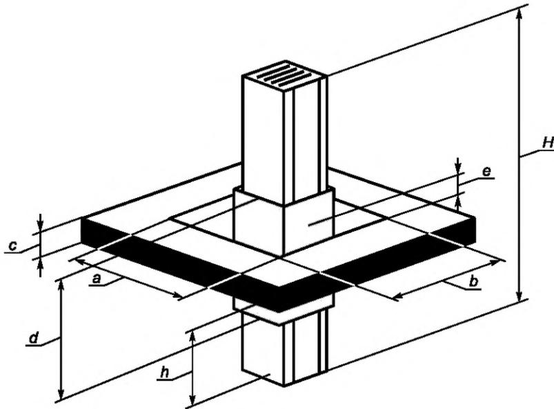
$a, b$  — ширина и длина отверстия испытательного пола;  $c$  — толщина испытательного пола;
