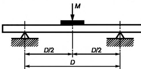
Рисунок 101 — Испытание механической нагрузкой прямого блока
