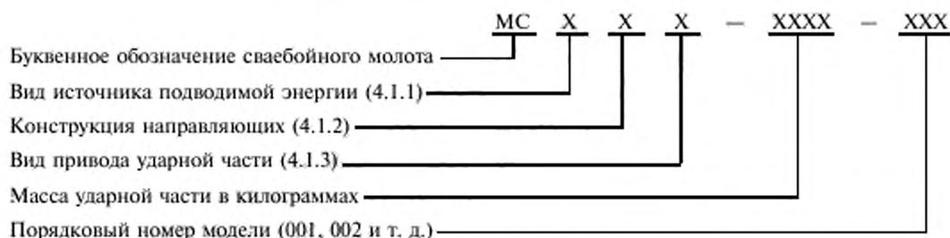
Пример условного обозначения сваебойного молота гидравлического штангового двойного действия с массой ударной части 2500 кг, третьей модели:
