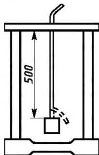
Рисунок 1 — Схема приспособления для испытания шнуров на растяжение
