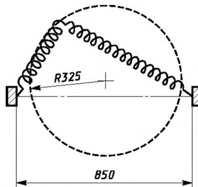
Рисунок 2 — Схема установки для испытания износоустойчивости спиральных шнуров
