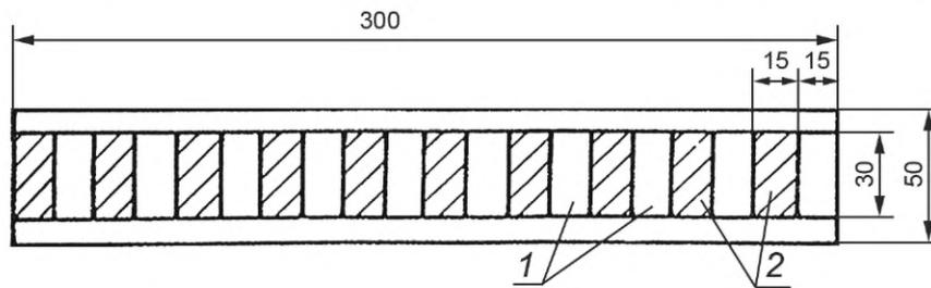
1 — площадь, через которую видна рабочая поверхность; 2 — образец эталона колера
