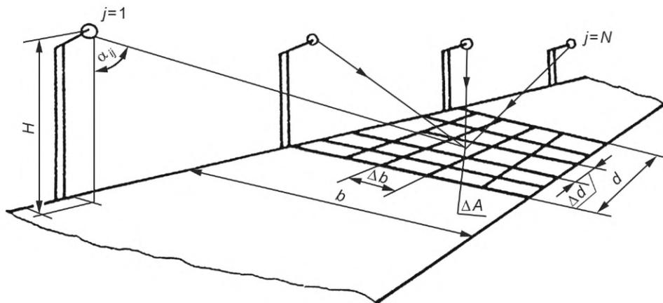
$d$  — длина контрольного участка;  $\Delta d$  — длина элементарной площадки;  $b$  — ширина проезжей части;  $\Delta b$  — ширина элементарной площадки;  $\Delta A$  — элементарная площадка;  $H$  — высота установки светильника;  $\alpha_{ij}$  — угол, ориентирующий направление силы света
