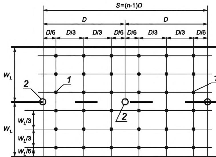
1 — точки измерения; 2 — осветительные приборы (ОП);  $S$  — длина контрольного участка (дорожного покрытия или стены);  $W_L$  — ширина полосы движения;  $D$  — шаг ОП;  $n$  — число ОП в ряду на контрольном участке (показано для  $n = 3$ );  $h$  — размер контрольного участка стены по высоте
