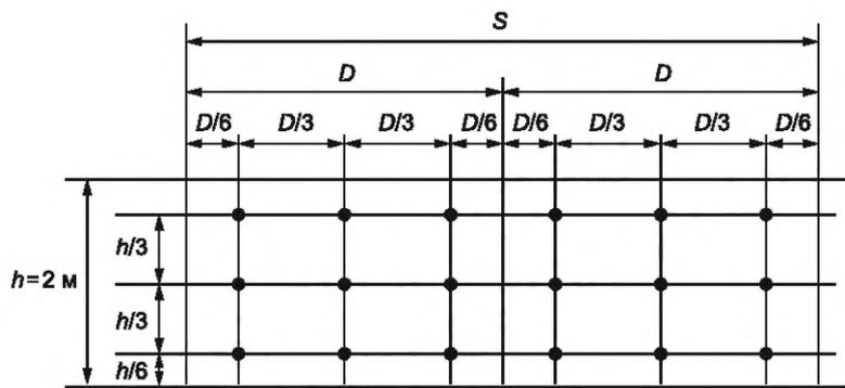
Рисунок Д.3 — Расположение контрольных точек на стене тоннеля
