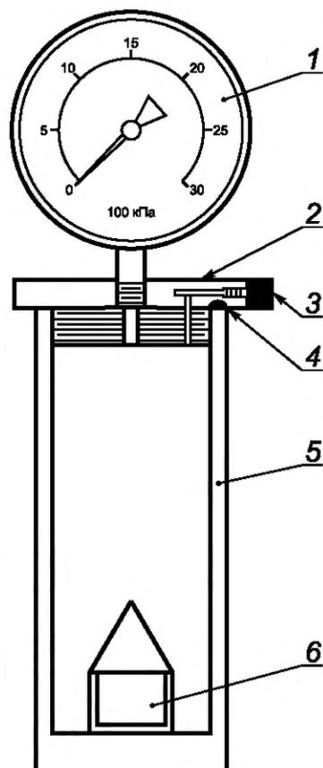
1 — манометр; 2 — крышка реакционного цилиндра; 3 — предохранительный клапан; 4 — уплотнительные кольца;
