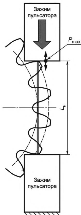
$P_{max}$  — расчетная динамическая нагрузка;  $L_H$  — длина общей нормали зубчатого колеса
