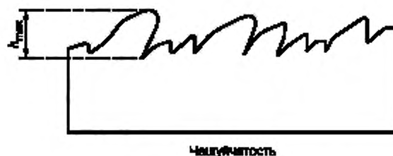
Рисунок А.35 — Чешуйчатость сварного шва
