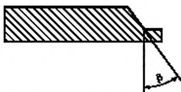
Рисунок Г.5 — Схема измерений угла скоса кромок \beta при наличии выступающего притупления
