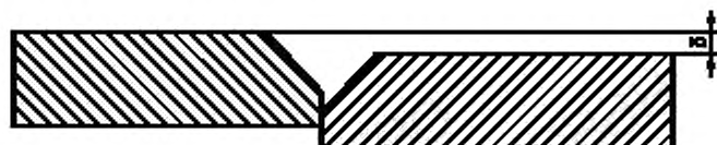
Рисунок Г.3 — Схема измерений смещения поверхностей \delta свариваемых или сваренных деталей
