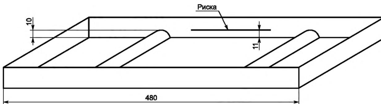
Рисунок 10 — Емкость для выдержки образцов в воде
