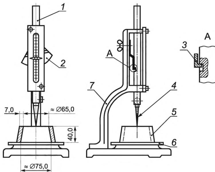
1 — подвижный стержень; 2 — пластинка-фиксатор подвижного стержня; 3 — пружинная пластина;
