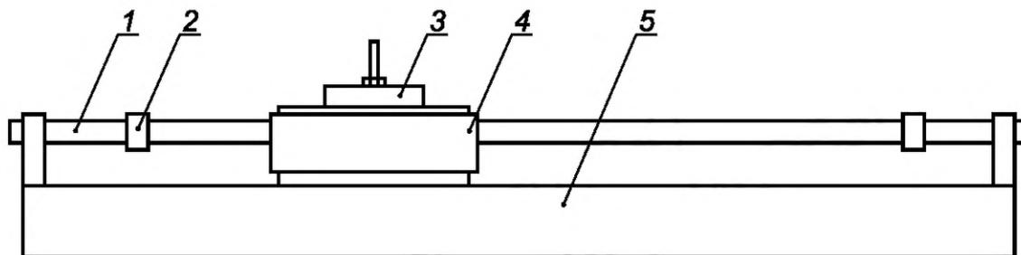
1 — стержни для крепления каретки; 2 — ограничители движения каретки; 3 — держатель шлифующей шкурки с пригрузом;
