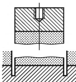
б) P/P: разрушение по слою затвердевшего раствора
