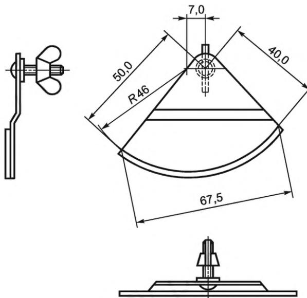
Рисунок 3 — Пластика-фиксатор подвижного стержня с конусом
