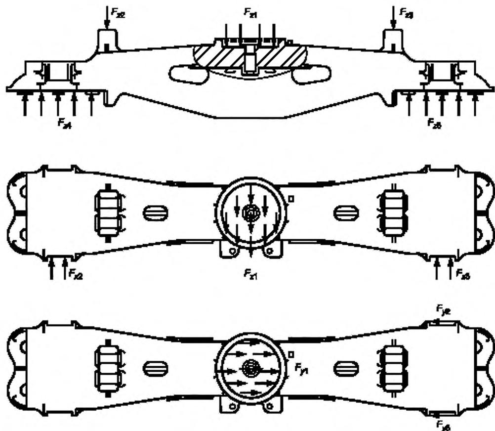
Рисунок 1 — Схема сил, действующих на надрессорную балку
