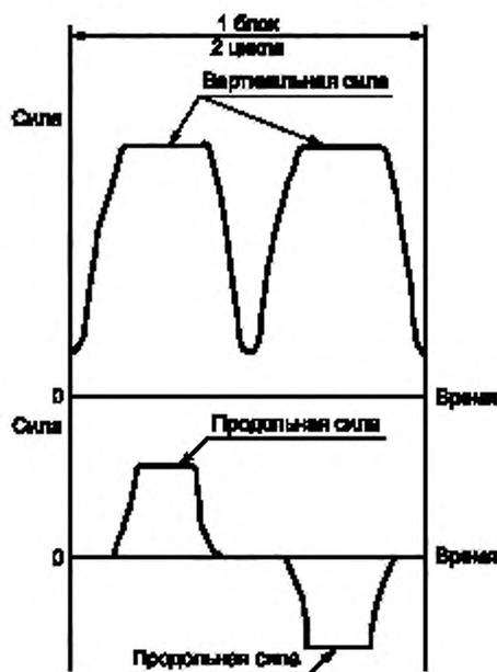
Рисунок 4 — Один блок приложения сил к надрессорной балке
