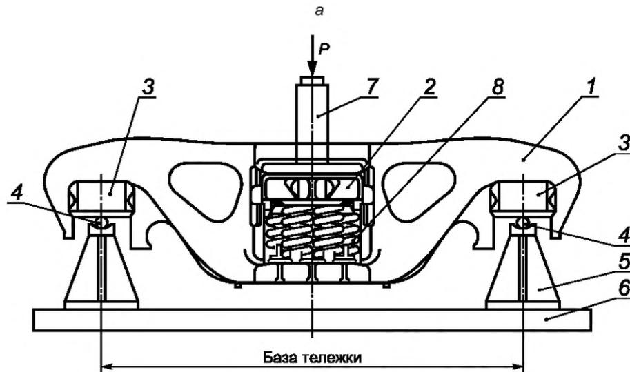
1 — боковая рама; 2 — концевая часть наддресорной балки (или наддресорная балка); 3 — переходник; 4 — цилиндрическая опора; 5 — опорная тумба; 6 — опорная поверхность; 7 — приспособление; 8 — рессорное подвешивание
