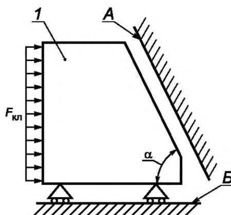
1 — фрикционный клин; А, Б — поверхности, имитирующие карман наддрессорной балки;
