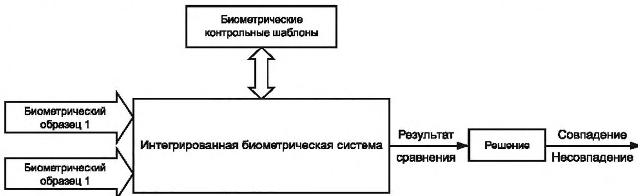
Рисунок F.4 — Объединение в интегрированной мультимодальной биометрической системе с результатом сравнения на выходе
