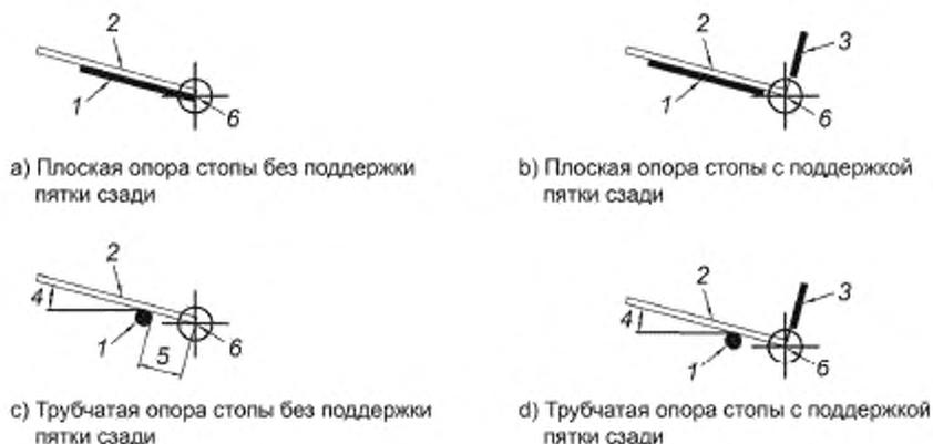
1 — опора стопы; 2 — стопа испытательного манекена; 3 — поддержка голеностопа сзади или поддержка стопы сзади;
