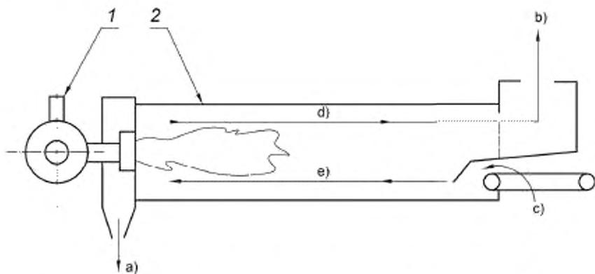
1 — горелка; 2 — сушильный барабан; а) — выход нагретого заполнителя; б) — выход газов к пылеуловителю;
