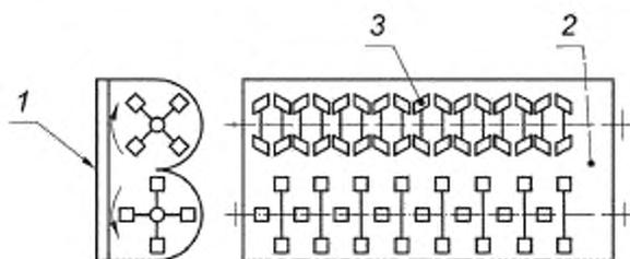
б) Двухвальный лопастной смеситель непрерывного действия
