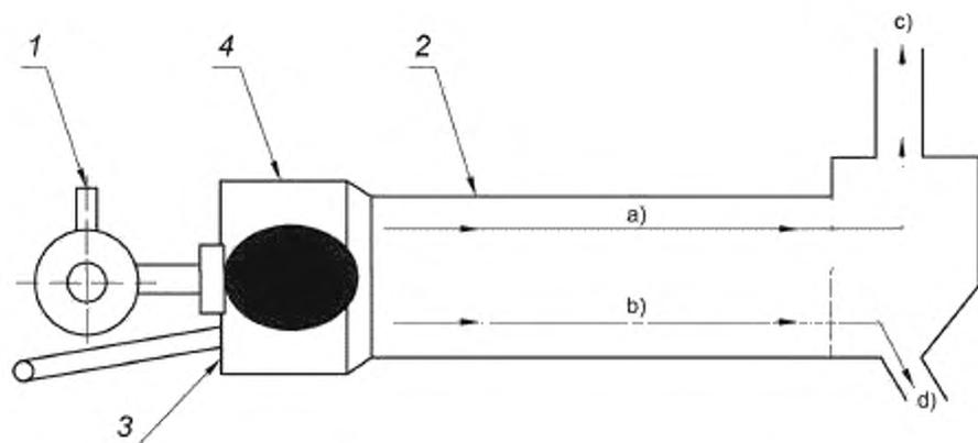
1 — горелка; 2 — сушильная камера вторично используемых материалов и УАП, 3 — подача УАП;
