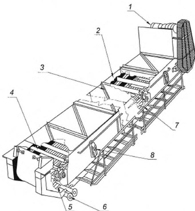
1 — редуктор; 2 — скребок; 3 — кожух; 4 — подшилник скольжения; 5 — натяжной механизм;
