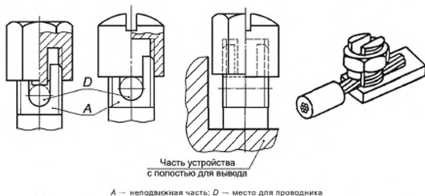
Примечание — Зажим резьбового типа, в котором проводник зажимается основанием прорези в резьбовом штифте с помощью гайки. Прижатие проводника осуществляется соответствующей формы шайбой под гайку или центральной шпилькой, если гайка колпачковая, или устройством равной эффективности, передающим давление от гайки проводнику внутри прорези.
