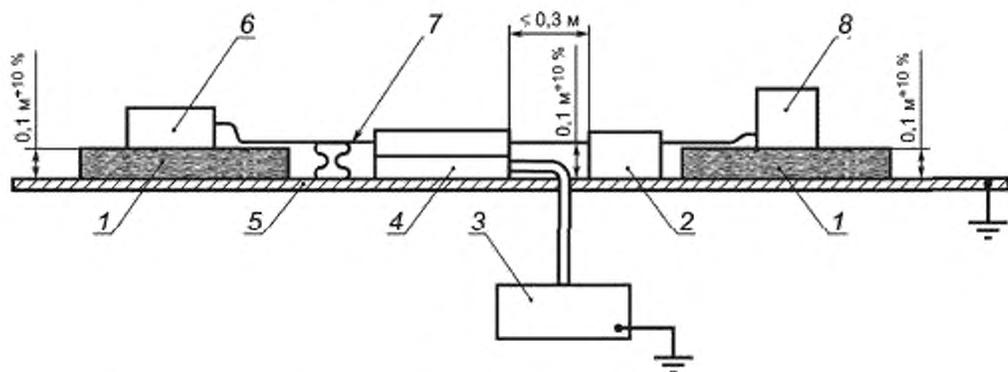
1 — изоляционная опора; 2 — развязывающее устройство; 3 — генератор радиочастоты; 4 — электромагнитные клещи; 5 — плата заземления; 6 — испытуемый аппарат (ИА); 7 — кабель ( $0,1 \text{ м} \leq \text{длина кабеля} \leq 0,3 \text{ м}$ ); 8 — вспомогательное оборудование
