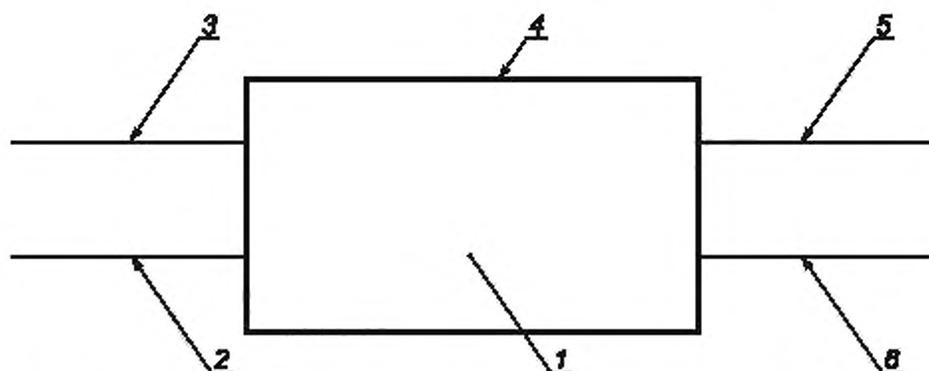
1 — оборудование/аппаратура, 2 — порт функционального заземления; 3 — вывод сигнальной цепи;
