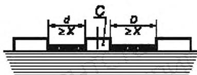
Воздушный зазор равен  $d + D$ .
