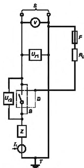
$S$  — источники питания;  $U_{r1}$ ,  $U_{r2}$  — датчики напряжения,  $V$  — вольтметр.  $F$  — плавкий элемент [8.3.3.5.2, перечисление g)];  $Z$  — цепь нагрузки (см. рисунок 8);  $R_L$  — токоограничивающие сопротивления;  $D$  — испытуемый аппарат (с присоединенными проводниками);  $B$  — перемычки для настройки контура;  $T$  — точка заземления (на стороне нагрузки или питания),  $I_1$  — датчик тока
