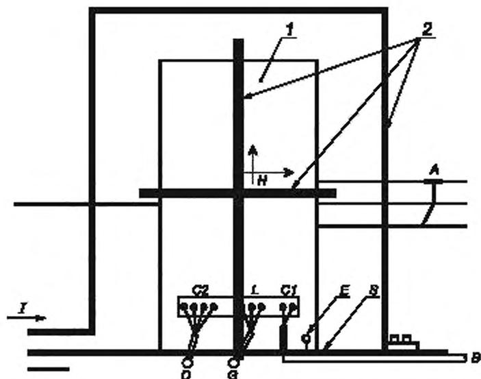
1 -- испытуемый аппарат (ИА); 2 -- катушка индуктивности; А -- заземление безопасности; В -- кабель подключения к источнику питания; С1 -- цепь источника питания; С2 -- сигнальная цепь; D -- кабель подключения к имитатору источника сигналов; Е -- вывод заземления; G -- кабель подключения к испытательному генератору; H -- сила электромагнитного поля; I -- индукционный ток; L -- линия связи; S -- изоляционная опора
