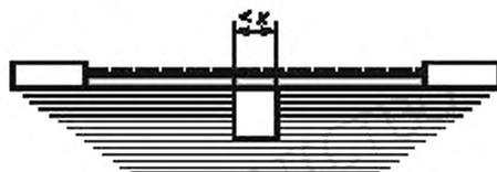
Условие: рассматриваемый путь утечки охватывает желобок с параллельными или сходящимися боковыми стенками любой глубины при ширине менее  $X$  мм.
