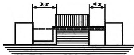
Условие: рассматриваемый путь охватывает не скрепленный стык с желобком шириной менее  $X$  мм с одной стороны и желобком шириной  $X$  мм и более с другой стороны.
