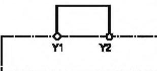
**Примечание 1** — Мостик между двумя выводами рассматривается как постоянно замкнутый контакт, а соответствующие выводы должны быть маркированы Y1 и Y2.
