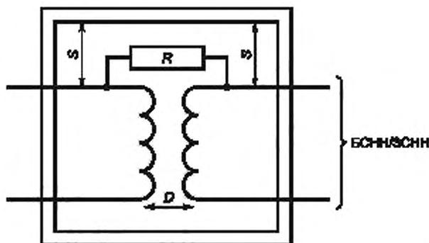
**D** — двойная (или усиленная) изоляция между цепями (включая цепь БСНН/ЗСНН). **R** — компонент, отвечающий требованиям к устройствам защитного полного сопротивления; **S** — основная изоляция
