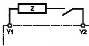
Примечание 2 — Соответствующие выводы объединенных полных сопротивлений и контактов, входящих во внешнюю цепь, должны быть маркированы Y1 и Y2.
