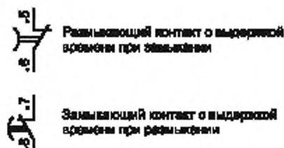
Выводы контактов переключателей на два направления, имеющих специальное назначение, обозначают цифрами функционального назначения 5, 6 и 8.
