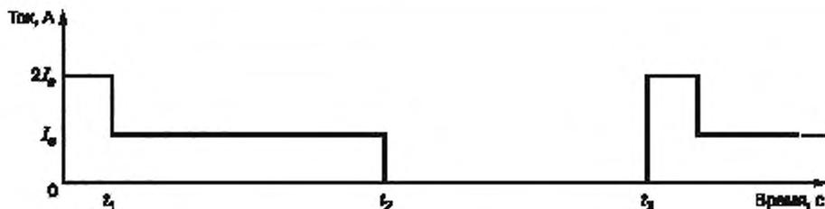
$t_1$  — время импульса = 10 мс;  $t_2$  — время включения;  $t_3 - t_2$  — время отключения (время отключения = время включения).
