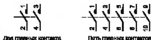
Если аппарат имеет более пяти главных контактов, то применяют буквенно-числовую маркировку, указанную в IEC 60445.
