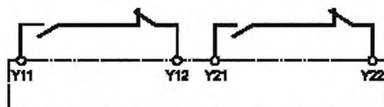
L.6.1.3.3 В случае трех выводов, предназначенных для подсоединения нескольких контактов, которые срабатывают одновременно (например, образуют переключающий контакт), они должны маркироваться Y1, Y2 и Y3, при этом Y1 — общий.
