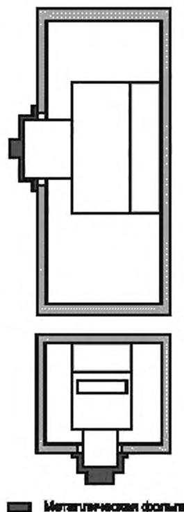
Рисунок R.1 — Механизм управления снаружи оболочки
