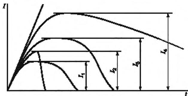
$I_1$  — первая калибровка;  $I_2$  — фактический ток отключения;  $I_3$  — вторая калибровка;  $I_4$  — отключающая способность
