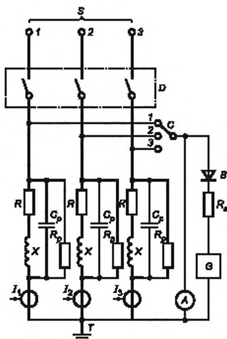
$S$  — источник питания;  $D$  — испытуемый аппарат;  $C$  — переключатель выбора фазы;  $B$  — диод;  $A$  — регистрирующий прибор;  $R_n$  — резистор;  $G$  — высокочастотный генератор;  $R$  — активные сопротивления цепи нагрузки;  $X$  — катушки индуктивности [8.3.3.5.2, перечисление d)];  $R_p$  — параллельные активные сопротивления;  $C_p$  — параллельные конденсаторы;  $I_1, I_2, I_3$  — датчики тока
