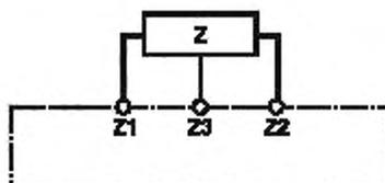
L.6.1.2.3 В случае более одного полного сопротивления их выводы должны маркироваться буквой Z и двузначными номерами, при этом первая цифра является порядковым номером.
