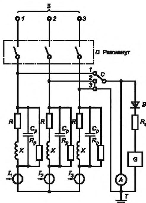
S — источник питания; D — испытуемый аппарат; C — переключатель выбора фазы; B — диод; A — регистрирующий прибор;  $R_a$  — резистор; G — высокочастотный генератор; R — активные сопротивления цепи нагрузки; X — катушки индуктивности [перечисление d) 8.3.3.5.2];  $R_p$  — параллельные активные сопротивления;  $C_p$  — параллельные конденсаторы;  $I_1, I_2, I_3$  — датчики тока
