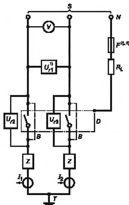
$S$  — источник питания;  $U_{r1}$ ,  $U_{r2}$ ,  $U_{r3}$  — датчики напряжения;  $V$  — вольтметр;  $N$  — нейтраль (искусственная);  $F$  — плавкий элемент [8.3.3.5.2, перечисление g)];  $Z$  — цель нагрузки (см. рисунок 8),  $R_L$  — токоограничивающее сопротивление;  $D$  — испытуемый аппарат (с присоединенными проводниками);  $I_1$ ,  $I_2$  — датчики тока;  $B$  — перемычки для настройки контура;  $T$  — точка заземления (на стороне нагрузки или питания)
