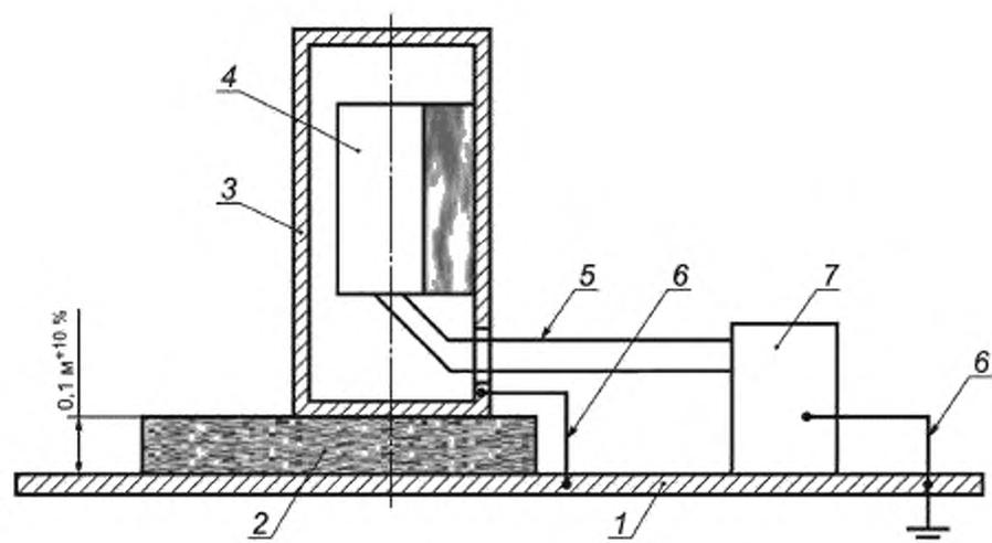
1 – плата заземления; 2 – изолирующая опора; 3 – металлическая оболочка (при наличии); 4 – испытуемый аппарат (ИА); 5 – соединительный кабель длиной  $0,9 \text{ м} \leq L \leq 1,0 \text{ м}$  (для исключения влияния емкостной связи); 6 – соединение для заземления ВЧ; 7 – генератор наносекундных импульсных помех
