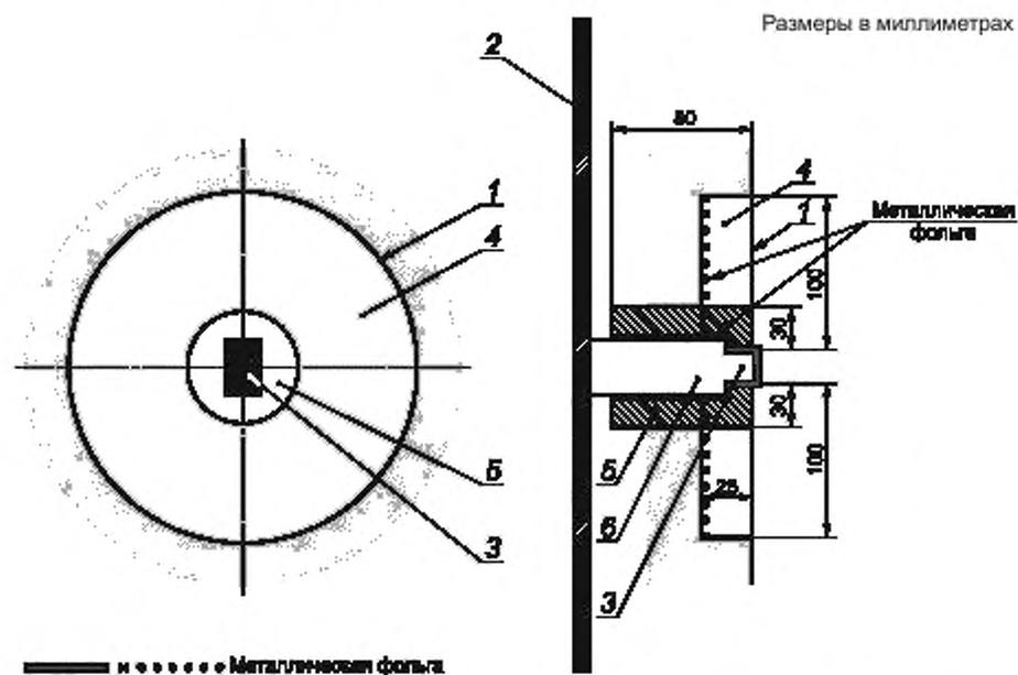
1 — область основания, ограниченная поверхностью органа управления, 2 — монтажная панель; 3 — нажимная кнопка;
