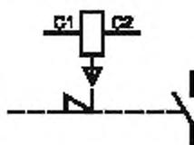
**Примечание** — Если в аппарате предусмотрено два независимых расцепителя (например, с разными номинальными параметрами), то выводы второго расцепителя обычно имеют маркировку C3, C4.
