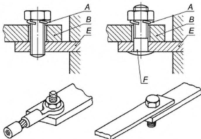
Зажим под наконечник — резьбовой или штифтовой зажим предназначен для зажима кабельного наконечника или шины с помощью винта или гайки.
