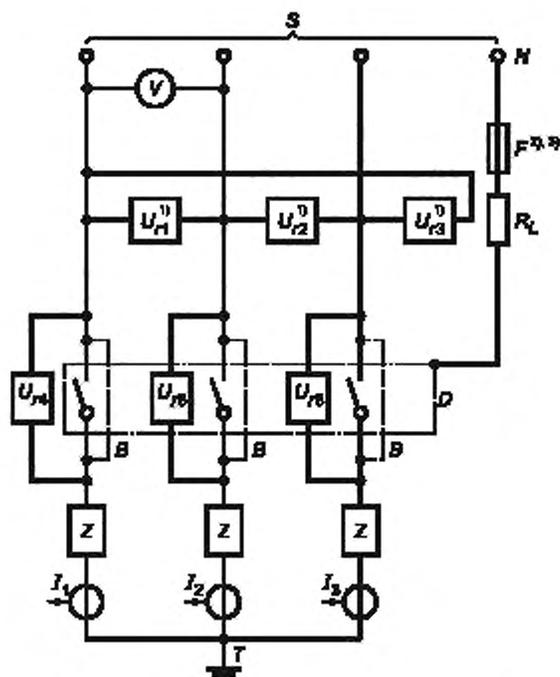
$S$  — источник питания;  $U_{v1}, U_{v2}, U_{v3}, U_{v4}, U_{v5}, U_{v6}$  — датчики напряжения;  $V$  — вольтметр;  $N$  — нейтраль (искусственная);  $F$  — плавкий элемент (см. 8.3.3.5.2, перечисление г));  $B$  — переключки для настройки контура;  $Z$  — цель нагрузки (см. рисунок 8);  $R_L$  — токоограничивающие сопротивления;  $D$  — испытуемый аппарат (с присоединенными проводниками);  $I_1, I_2, I_3$  — датчики тока;  $T$  — точка заземления (на стороне нагрузки или питания)
