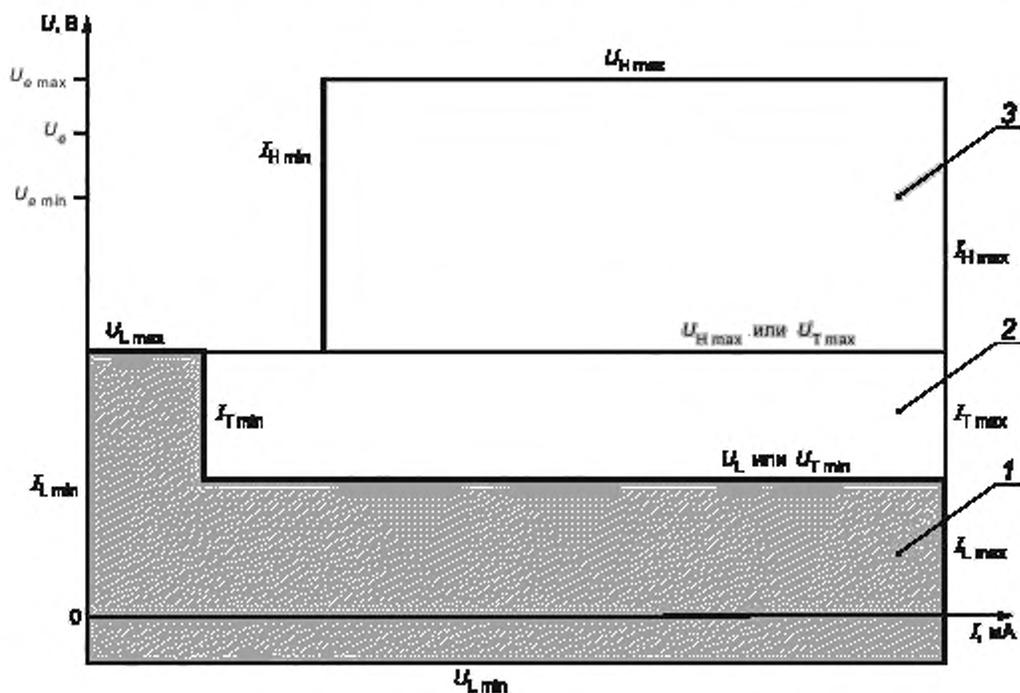
1 — область закрытого состояния («откл.», состояние 0); 2 — переходная область;
