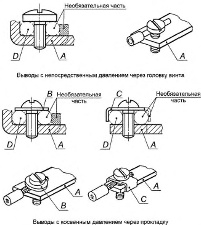
A - неподвижная часть; B - шайба или прокладка; C - устройство, препятствующее выскальзыванию проводников; D - место для проводника
