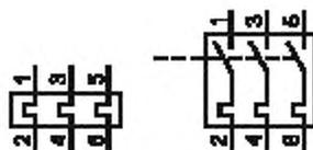
В аппаратах с защитой от перегрузок выводы вспомогательного контакта имеют ту же маркировку, что и контакт специального назначения (см. L.3.2.1.2), но с порядковым номером 9.
