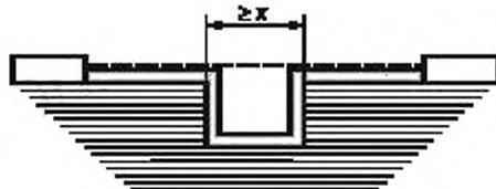
Условие: рассматриваемый путь охватывает желобок с параллельными боковыми стенками любой глубины шириной  $X$  мм или более.
