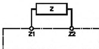
L.6.1.2.2 Выводы ответвлений полного сопротивления Z с ответвлениями должны иметь последовательную порядковую маркировку Z3, Z4 и т. д.
