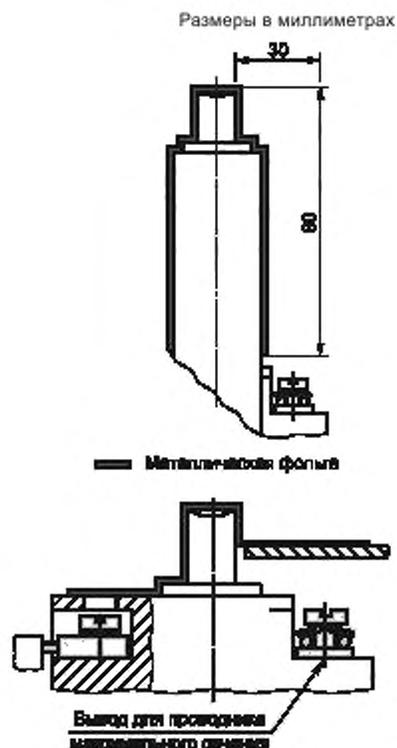
Примечание — Отверстия, в которые не может проникнуть испытательный палец, могут не покрываться металлической фольгой (на усмотрение изготовителя).
