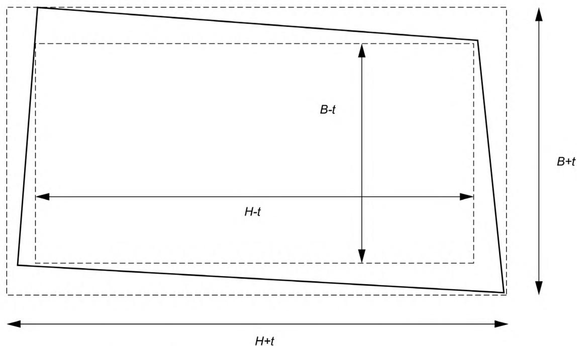
Рисунок 2 — Определение длины, ширины и прямоугольности
