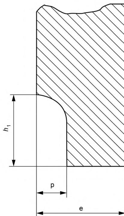
Рисунок 4 — Дефект в виде скола — вид кромки
