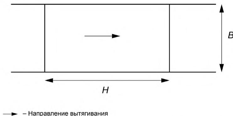
Рисунок 1 — Длина, ширина и направление вытягивания
