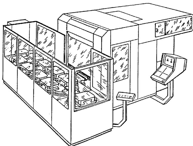
Рисунок С.2 — Общий вид обрабатывающего центра, представленного на рисунке С.1
