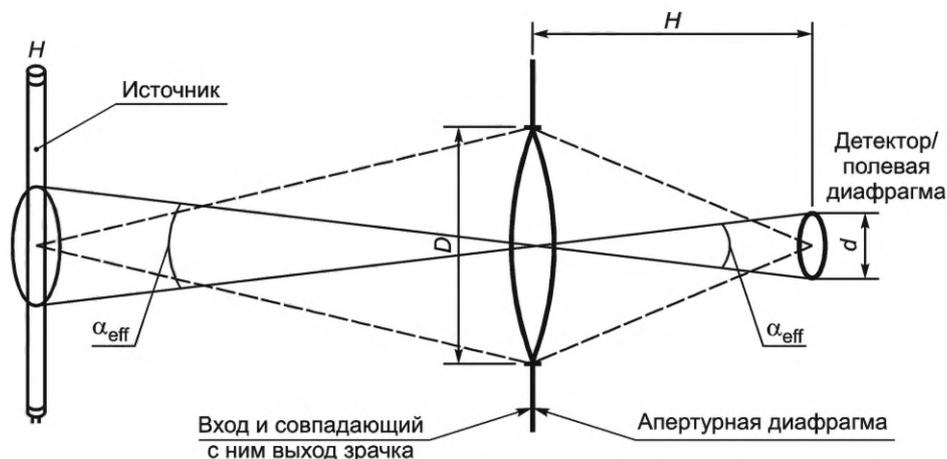
Рисунок 5.2 — Пример формирователя изображения для измерений энергетической яркости
