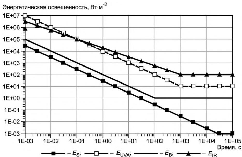
Рисунок 5.4 — Пределы взвешенных значений энергетической освещенности в зависимости от времени постоянного воздействия
