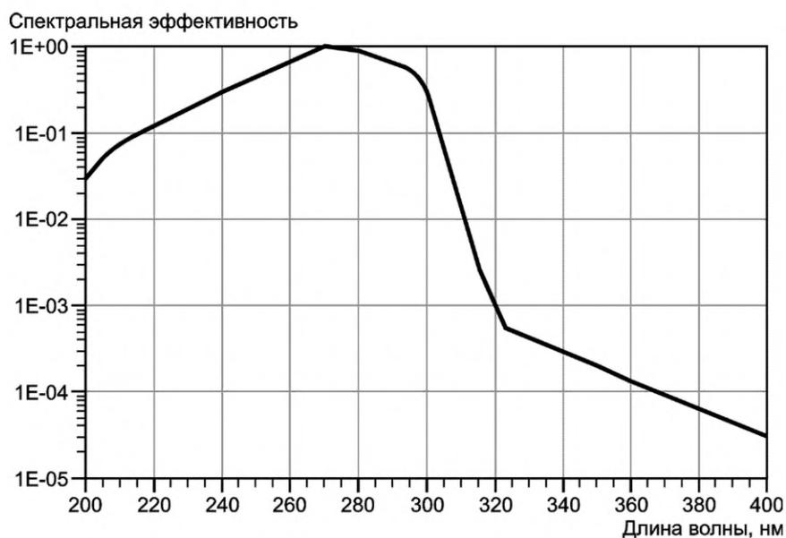
Рисунок 4.1 — Спектральная весовая функция актиничной ультрафиолетовой опасности  $S_{UV}(\lambda)$
