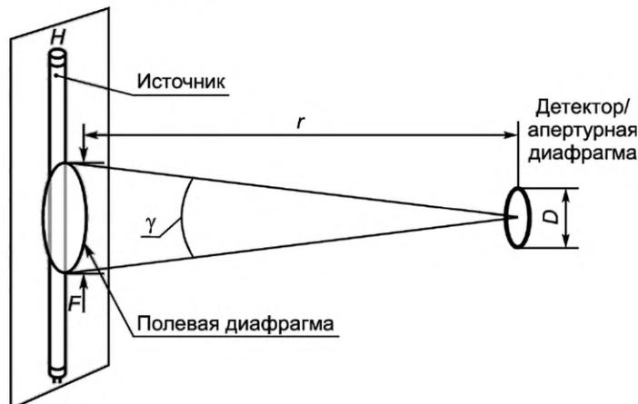
Рисунок 5.3 — Альтернативный метод измерения энергетической яркости
