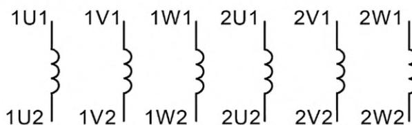
Рисунок 15 — Шестифазная обмотка, разомкнутое соединение, шесть элементов
