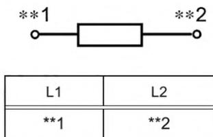
Рисунок 25 — Однофазное одиночное напряжение
