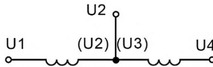
Рисунок 8 — Два элемента, внутреннее соединение, три вывода
