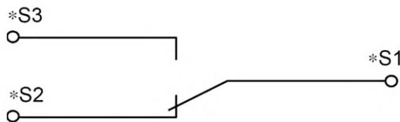
Рисунок 33 — Соединения переключателя
