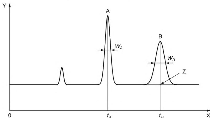
Рисунок 1 — Вычисление разрешающей способности между пиками А и В
