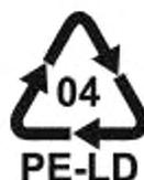
Рисунок В.4 — Полиэтилен, низкой плотности (PE-LD)
