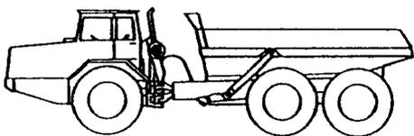
Рисунок G.5 – Землевоз с шарнирно-сочлененной рамой
