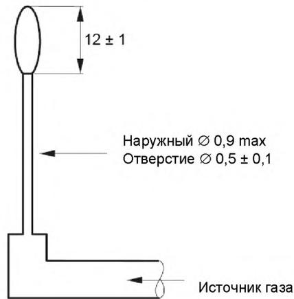
Рисунок 1а – Регулировка пламени
