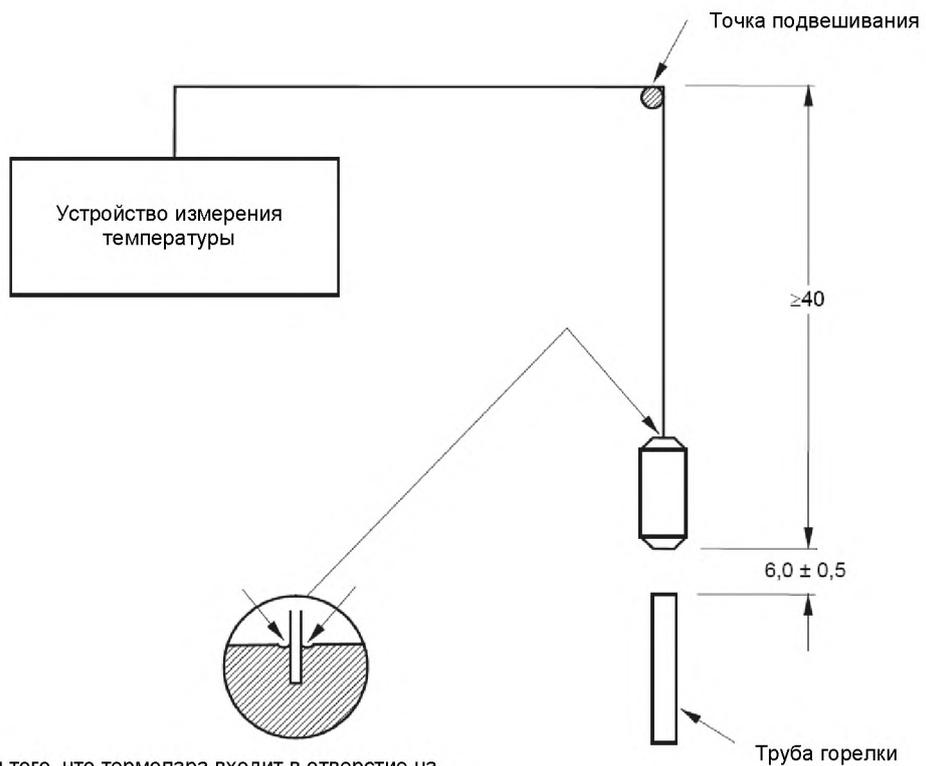
После проверки того, что термопара входит в отверстие на полную глубину, медь обжимают вокруг термопары без повреждения термопары
