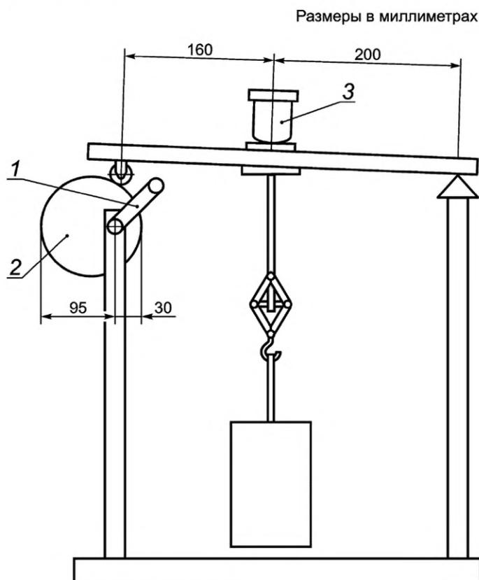
1 — ручка; 2 — эксцентрик; 3 — испытуемый образец
