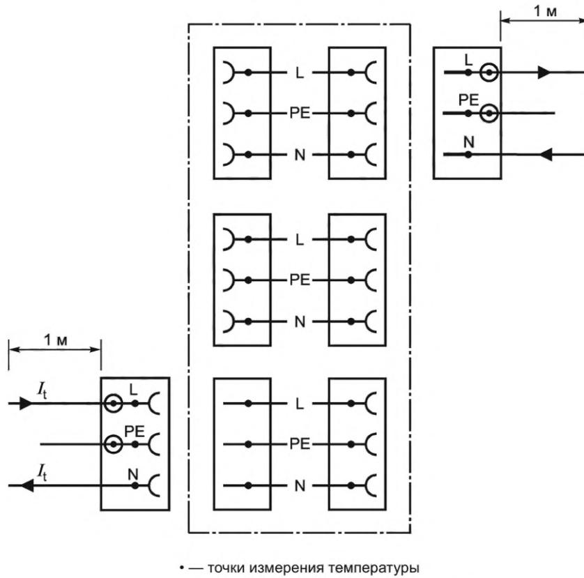
Рисунок В.3 — Испытательная схема соединения распределительных щитов 1P+N+PE, фаза и N под нагрузкой
