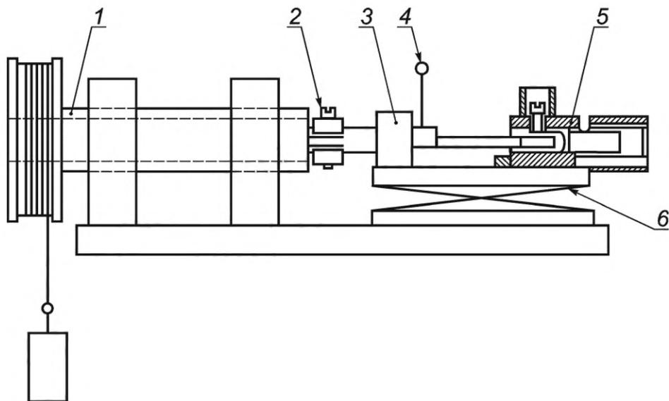
1 — ось вращения для скручивания; 2 — кабельный зажим для испытания кабеля;
