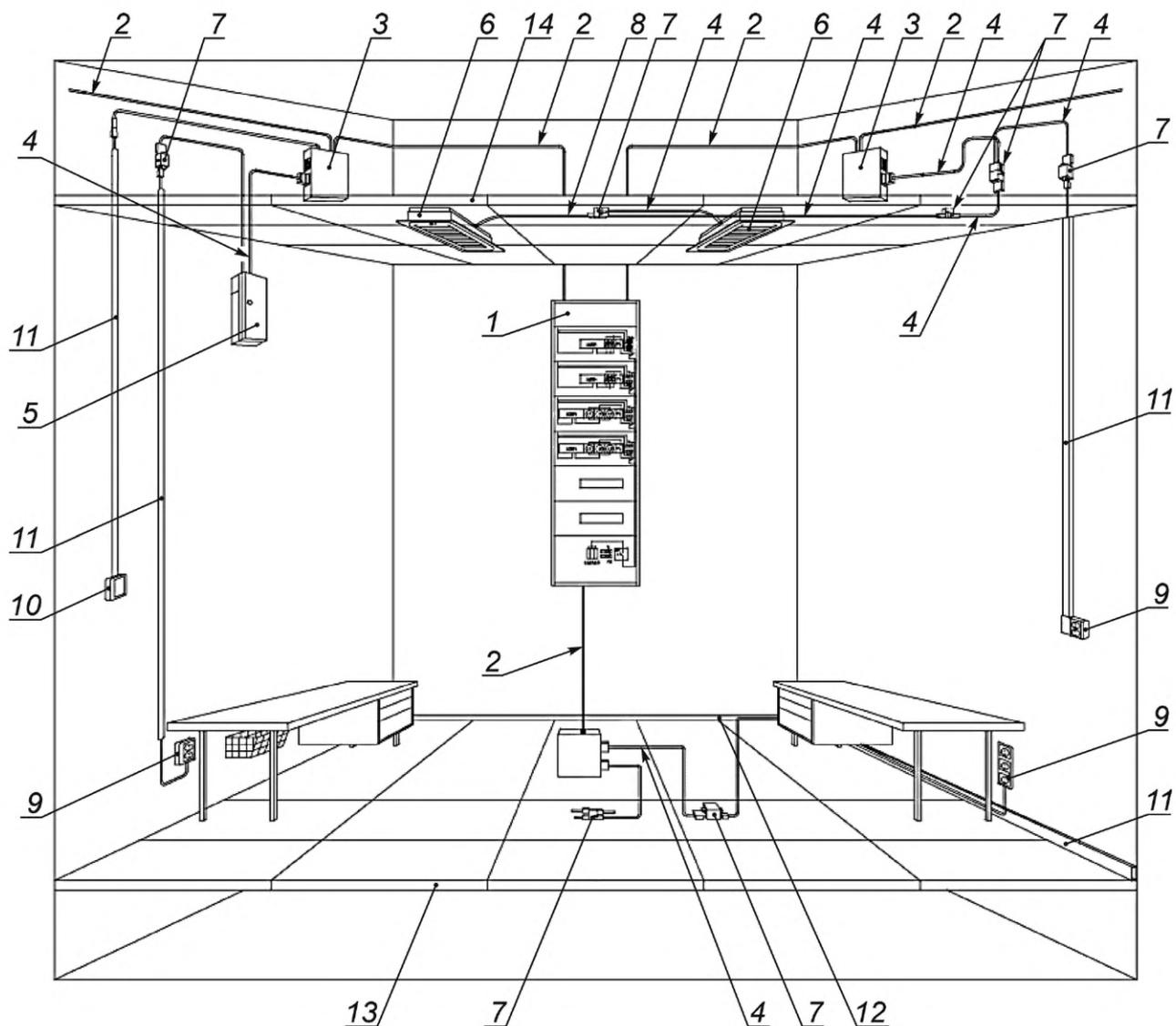
1 — распределительный щит; 2 — главный кабель (гибкая установка); 3 — распределительная коробка; 4 — комплект армированных кабелей от изготовителя; 5 — малый распределительный щит; 6 — светильник; 7 — распределительный щит; 8 — комплект армированных кабелей от изготовителя; 9 — приборная розетка; 10 — выключатель; 11 — короб; 12 — кабельный (вентиляционный) канал; 13 — подвесной пол; 14 — подвесной потолок
