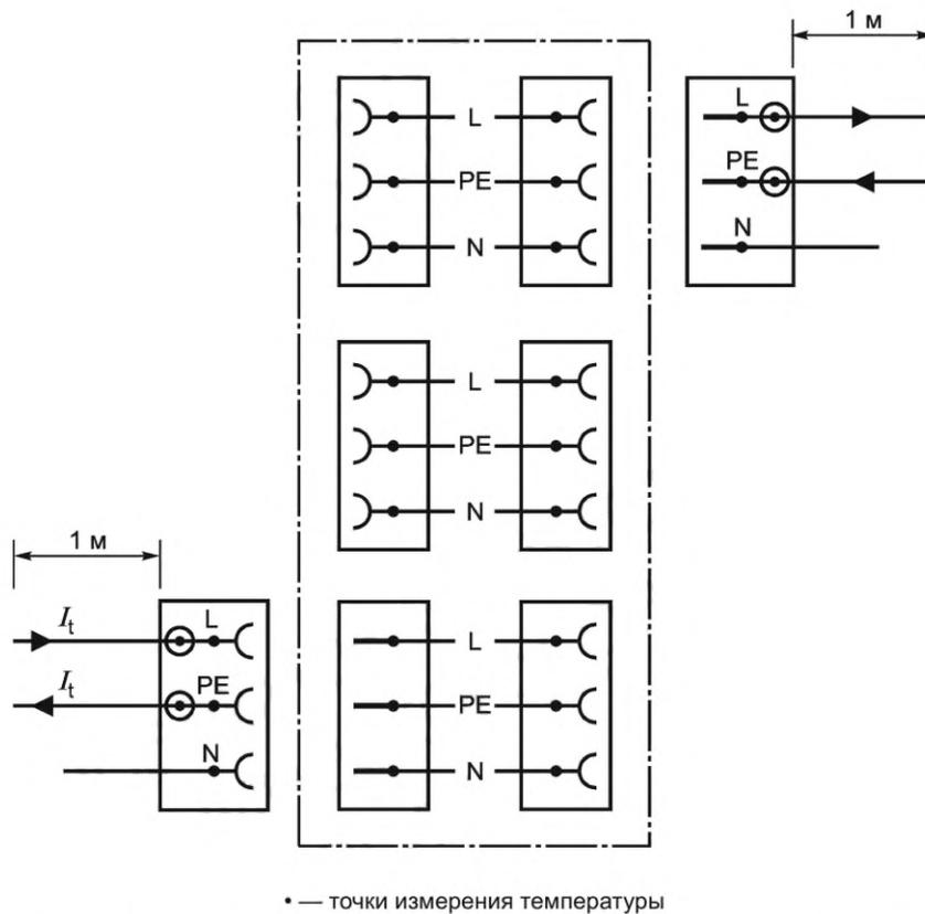
Рисунок В.4 — Испытательная схема соединения 1P+N+PE распределительных щитов, фаза и PE под нагрузкой
