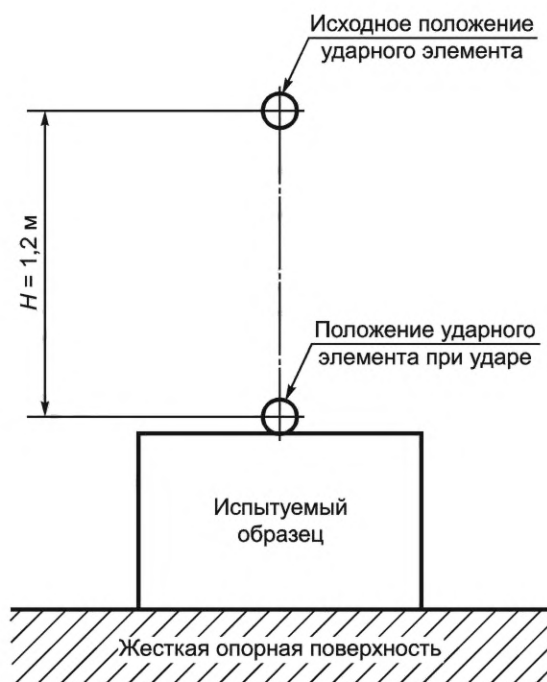
Рисунок 101 — Испытание на удар горизонтальной поверхности
