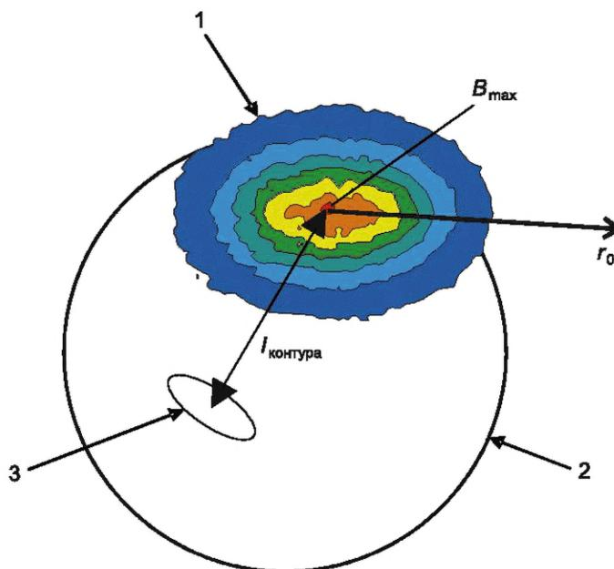
1 — измерение по касательной плоскости вокруг точки с максимальной интенсивностью; 2 — модель бытового электрического прибора в виде сферы; 3 — контур в качестве эквивалентного источника поля
