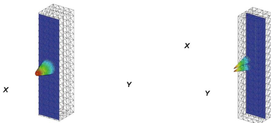
Рисунок С.8 — Распределение плотности электрического тока  $J$  в плоскостях  $x = +0,2$  м (левая часть рисунка) и  $y = 0,0$  м (правая часть рисунка)
