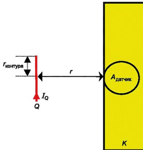
Рисунок С.15 — Расположение источника Q, датчика и модели К
