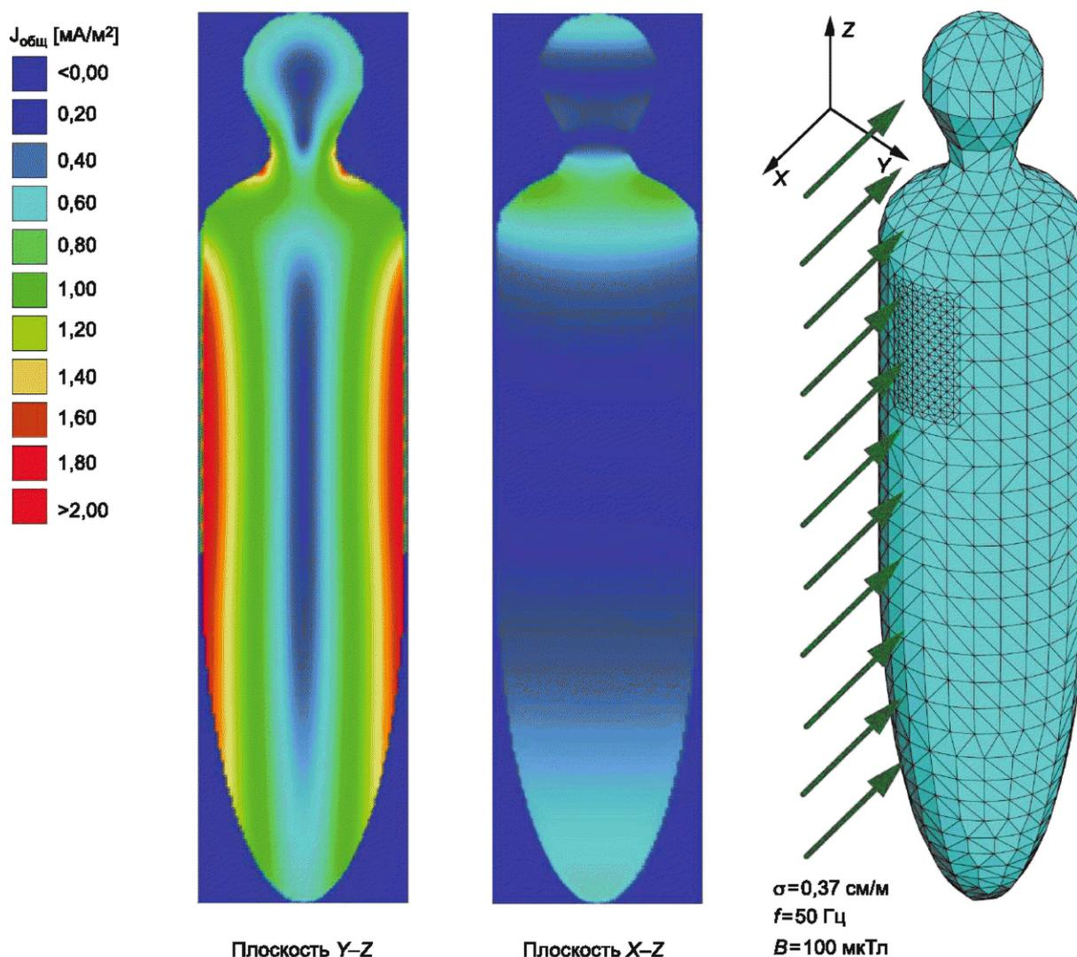
Рисунок С.13 — Распределение плотности индуцированного электрического тока
