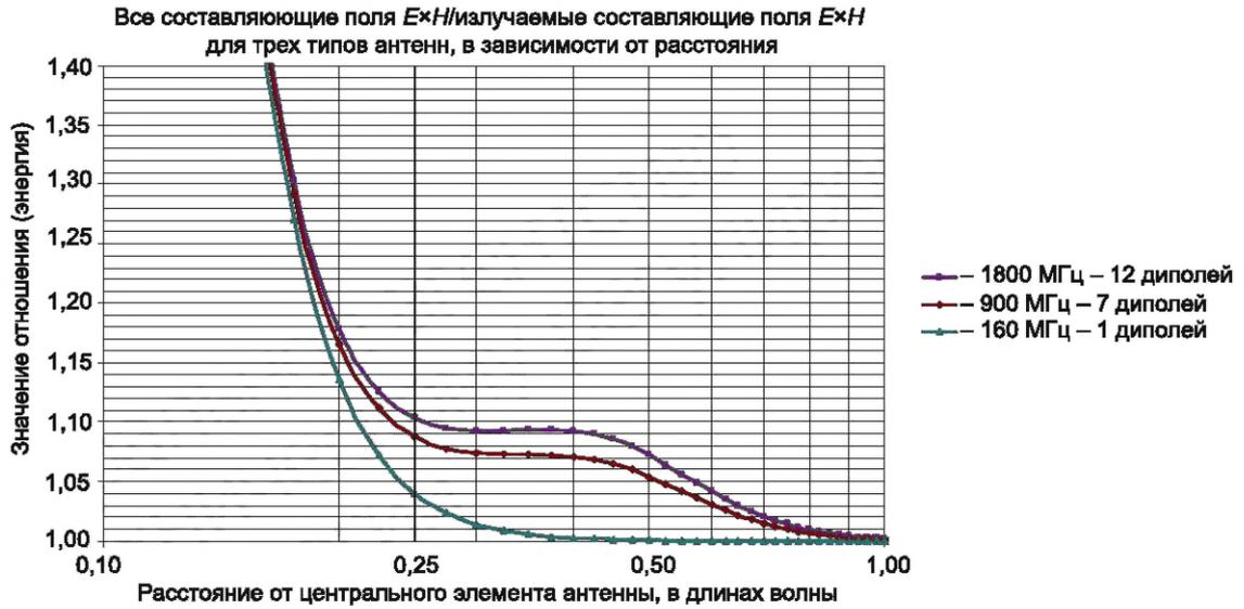
**А.5 Пример расчета области поля при частоте 900 МГц (см. рисунок А.5)**
