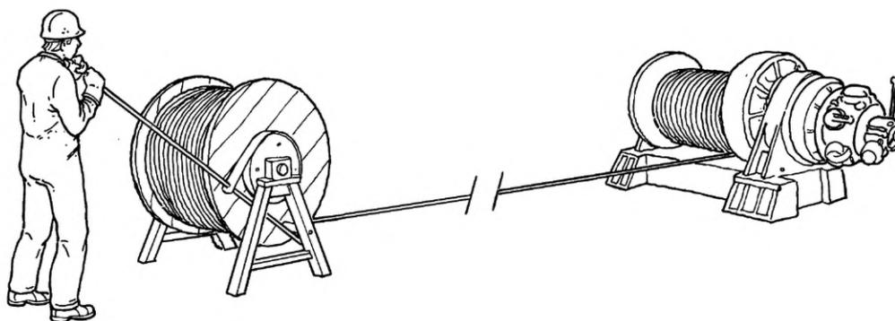
Рисунок А.2 — Перематывание стального троса с катушки на барабан с контролем натяжения каната — от нижней части катушки к нижней части барабана
