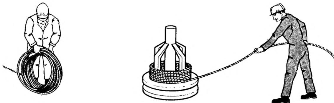
Рисунок А.1 — Способы разматывания каната из бухты
