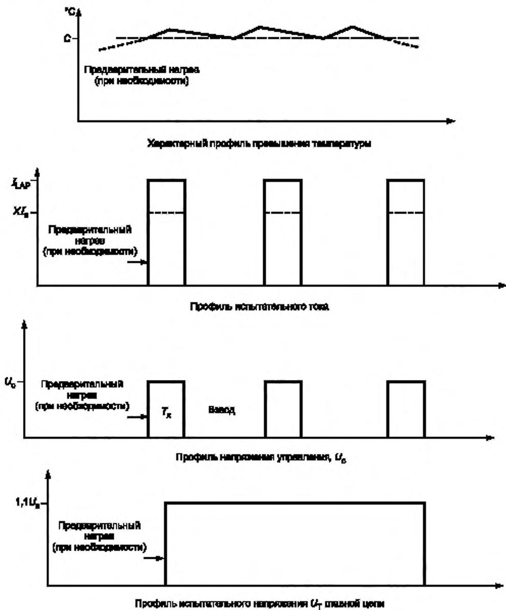
Рисунок F.2 — Профиль испытания на перегрузочную способность
