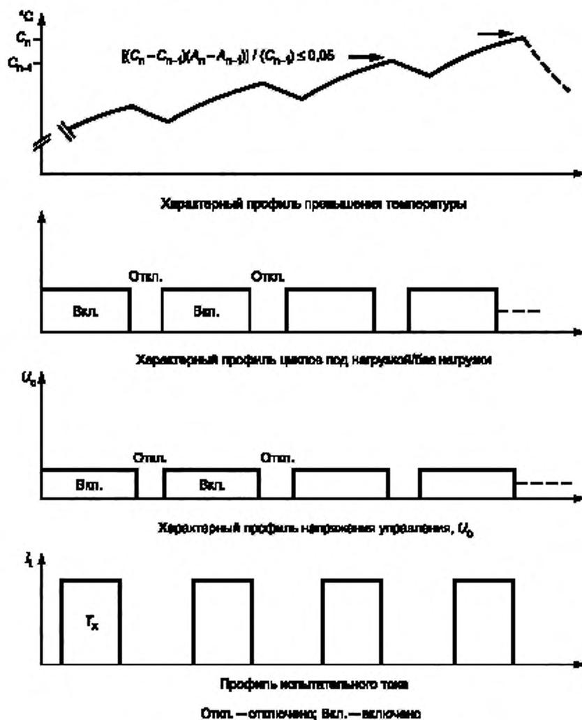
Рисунок F.1 — Профиль испытания на тепловую стабильность
