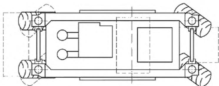
Рисунок А.1 — Стабилизатор грунта с центральным расположением фрезерного барабана с горизонтальной осью вращения
