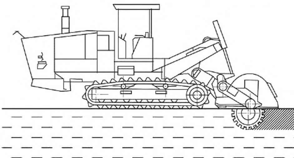
Рисунок А.4 — Гусеничный стабилизатор грунта с задним расположением фрезерного барабана с горизонтальной осью вращения
