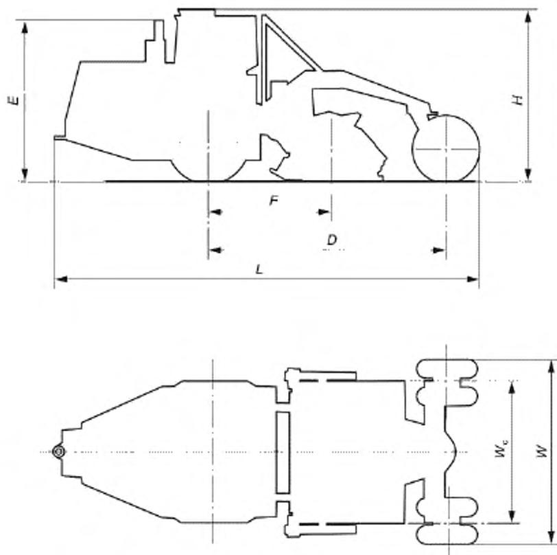
$L$  — габаритная длина;  $W$  — габаритная ширина;  $H$  — габаритная высота.  $E$  — высота без кабины;  $D$  — расстояние между осями;  $F$  — расстояние между осью фрезерного барабана и передней осью.  $W_c$  — габаритная ширина смесительной камеры
