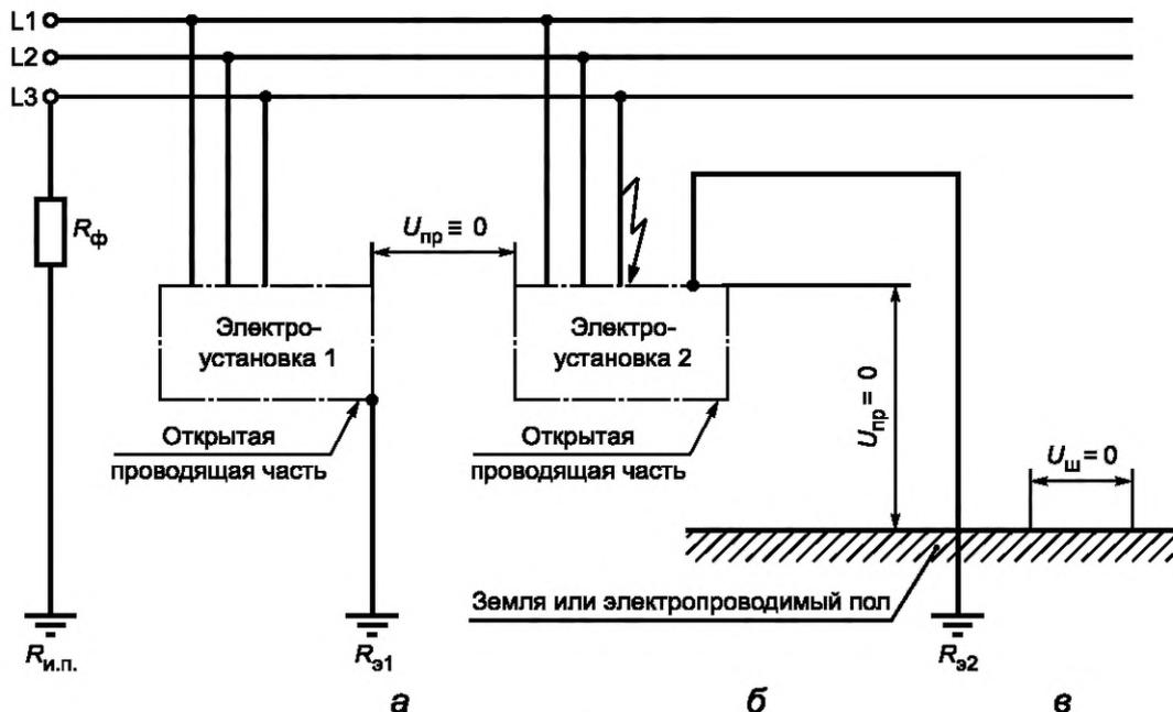
$U_{\text{пр}}$  — напряжение прикосновения;  $U_{\text{ш}}$  — шаговое напряжение;  $R_{\text{и.п.}}$  — заземлитель источника питания;  $R_{\text{з1}}$  — сопротивление заземления электроустановки 1;  $R_{\text{з2}}$  — сопротивление заземления электроустановки 2;  $R_{\text{ф}}$  — сопротивление в заземляющем проводнике фазы источника питания
