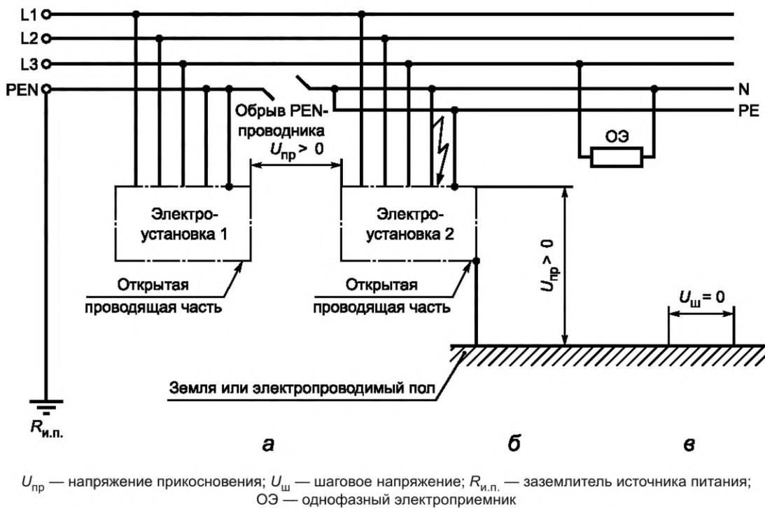
Рисунок В.3 — Сеть TN-C-S с обрывом PEN-проводника
