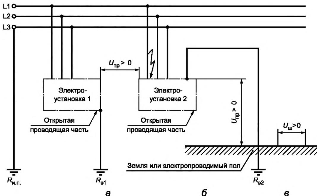
$U_{пр}$  — напряжение прикосновения;  $U_{ш}$  — шаговое напряжение;  $R_{и.п.}$  — заземлитель источника питания;  $R_{з1}$  — сопротивление заземления электроустановки 1;  $R_{з2}$  — сопротивление заземления электроустановки 2
