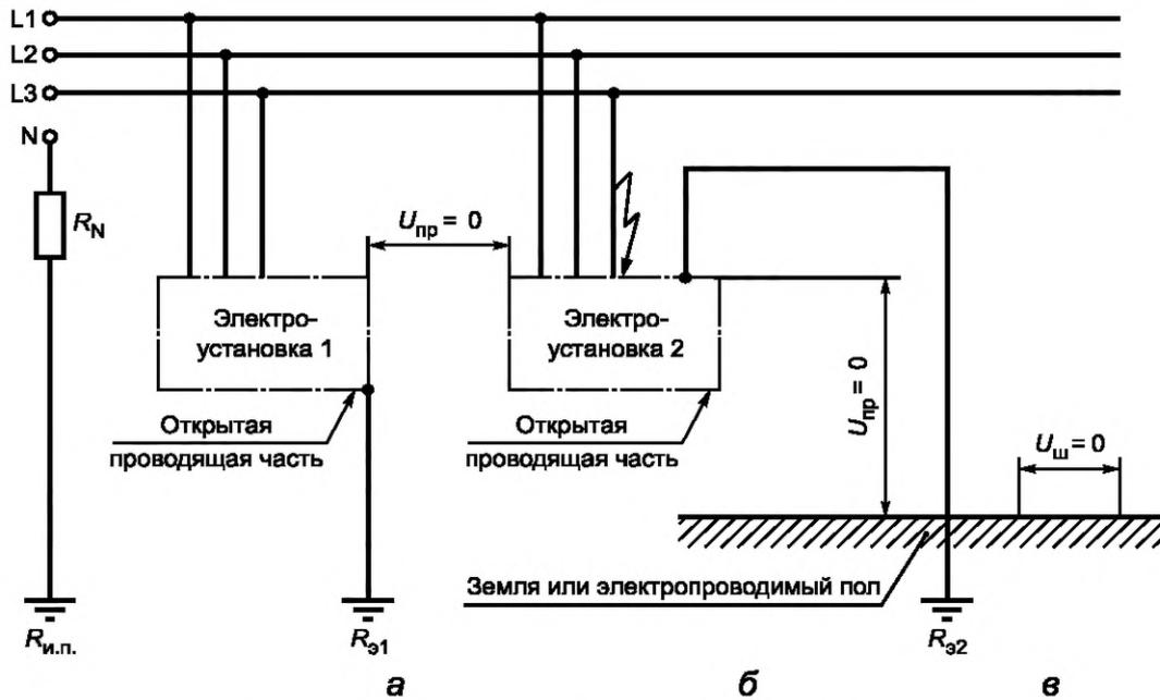
$U_{\text{пр}}$  — напряжение прикосновения;  $U_{\text{ш}}$  — шаговое напряжение;  $R_{\text{и.п.}}$  — заземлитель источника питания;  $R_{\text{з1}}$  — сопротивление заземления электроустановки 1;  $R_{\text{з2}}$  — сопротивление заземления электроустановки 2;  $R_{\text{N}}$  — сопротивление в заземляющем проводнике нейтрали источника питания
