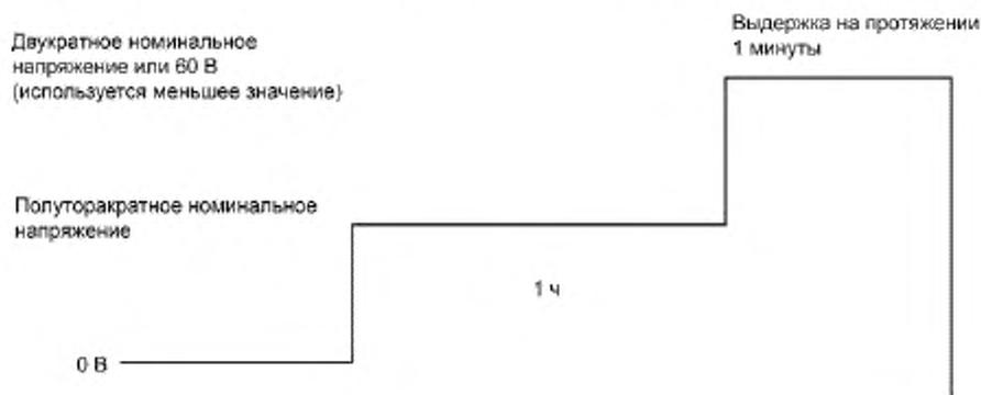
Рисунок 2 — Цикл испытания на воздействие повышенных электрических напряжений
