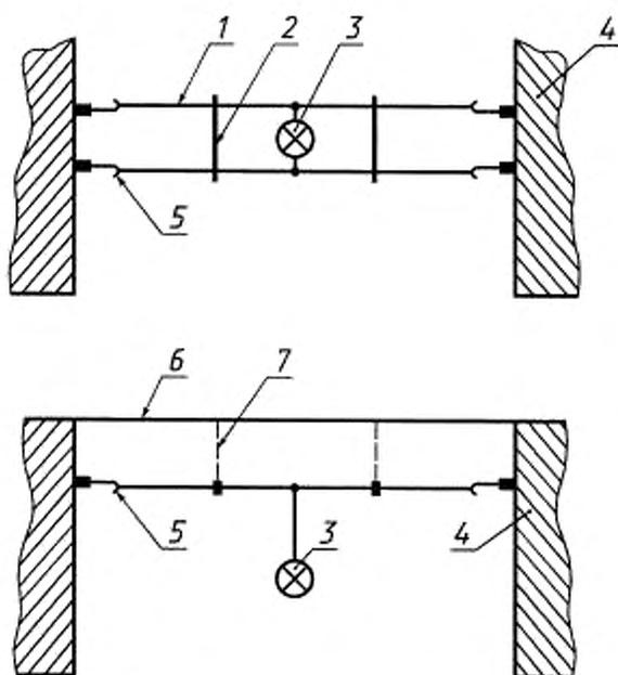
1 — несущий проводник, 2 — распорка; 3 — светильник; 4 — стена;
