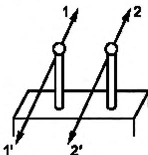
1 — опускание; 1' — подъем; 2 — наклон вперед; 2' — наклон назад
