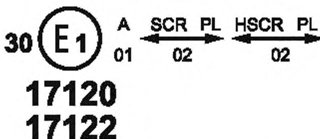
Приведенный выше пример соответствует маркировке рассеивателя из пластических материалов, предназначенного для использования в различных типах фар, а именно:
