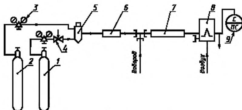
1 — баллон с анализируемым газом; 2 — баллон с газом-носителем; 3 — редуктор баллона; 4 — пентиль тонкий регулировочный; 5 — дозатор; 6 — газохроматографическая колонка; 7 — реактор; 8 — детектор пламенно-ионизационный; 9 — измерительный прибор
