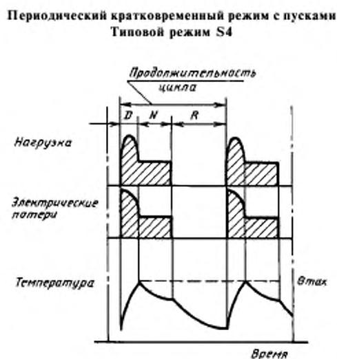
$D$  — пуск;  $N$  — работа при постоянной нагрузке;  $R$  — состояние покоя;  $\theta_{\max}$  — максимальная температура, достигнутая в течение цикла.
