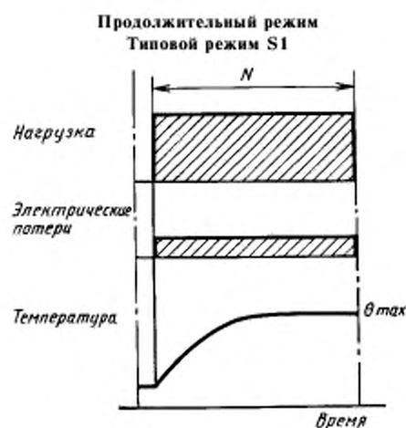
$N$  — работа при постоянной нагрузке;
