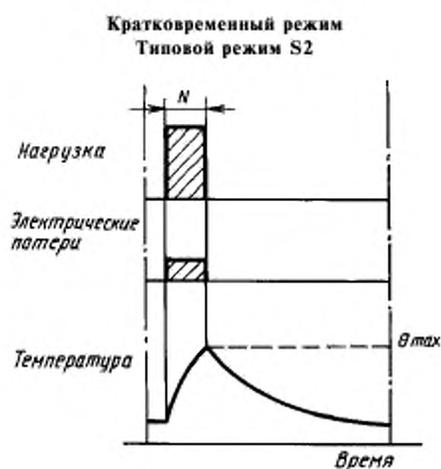
$N$  — работа при постоянной нагрузке;  $\theta_{\max}$  — максимальная температура, достигнутая в течение цикла
