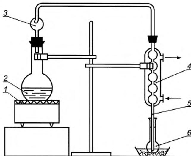
1 — электроплитка, 2 — перегонная колба (плоскодонная или круглодонная), 3 — каплеуловитель, 4 — холодильник (ХПТ или ХШ); 5 — стеклянная трубка; 6 — приемная колба
