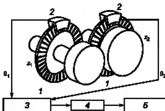
1 — измерительный преобразователь вращательного движения; 2 — считывающее устройство;
