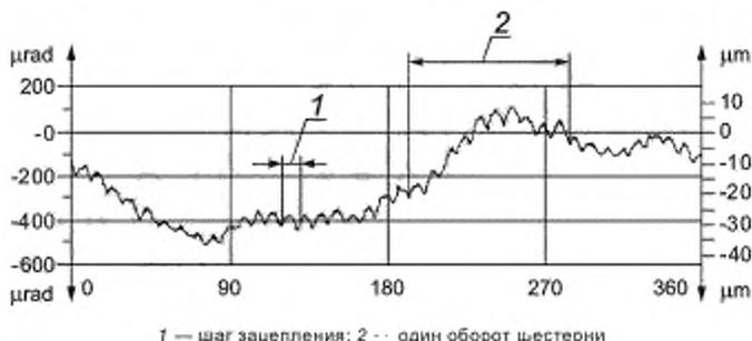
Рисунок F.2 — Пример кинематической погрешности
