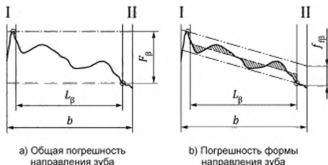
Рисунок 15 — Утолщение зуба при контроле направления зуба
