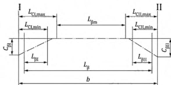
I — базовый торец; II — не базовый торец;  $C_{\beta I}$  — значение от среза торца;  $C_{\beta II}$  — значение от среза торца;  $L_{CI, \max}$  — максимальная длина от среза торца;  $L_{CI, \min}$  — минимальная длина от среза торца;  $L_{CII, \max}$  — максимальная длина от среза торца;  $L_{CII, \min}$  — минимальная длина от среза торца;  $L_{\beta I}$  — зона среза торца;  $L_{\beta M}$  — средняя зона направления линии зуба;  $L_{\beta II}$  — зона среза торца
