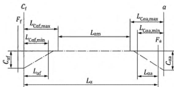
$C_{ca}$  — утолщения головки зуба при С-модификации;  $C_{of}$  — утолщения ножки зуба при С-модификации;  $L_{am}$  — средняя зона профиля;  $L_{ca,max}$  — модификации головки зубьев, максимальная длина;  $L_{ca,min}$  — модификации головки зубьев, минимальная длина;  $L_{caf,max}$  — модификации ножки зубьев, максимальная длина;  $L_{caf,min}$  — модификации ножки зубьев, минимальная длина;  $L_{ca}$  — зона модификации головки профиля;  $L_{of}$  — зона модификации ножки профиля;
