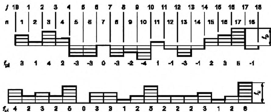
$f_{pi}$  — функциональная погрешность  $i$ -тых шагов;  $f_{ij}$  — функциональная разность соседних  $i$ -тых шагов;
