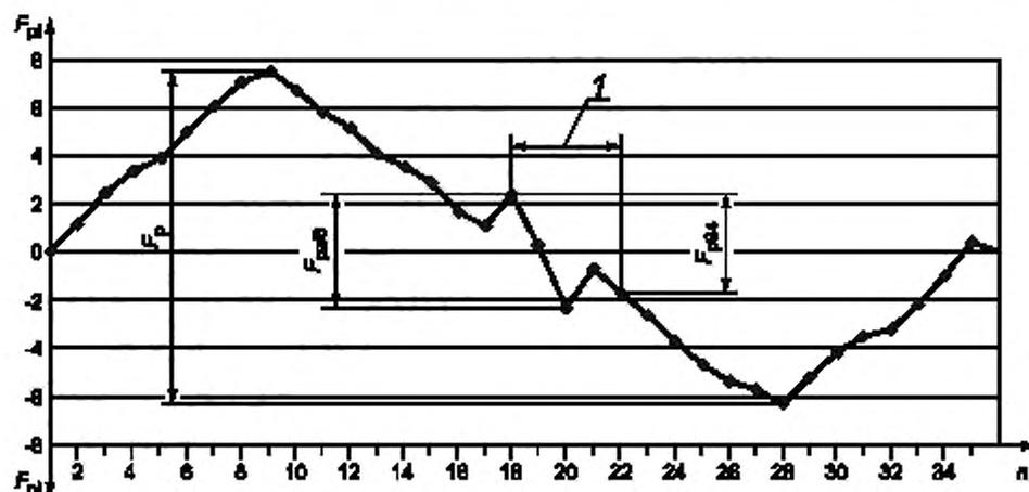
1 — 4 шага сектора с самой большой зубной погрешностью;  $n$  — номер зуба;  $F_p$  — общая накопленная погрешность шага,  $F_{pz/8}$  — накопленная погрешность шага по сектору ( $z/8 = 4$ );  $F_{pS4}$  — накопленная погрешность  $k$  шагов, 4 зуба
