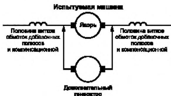
Рисунок 5 — Дополнительный генератор, используемый для увеличения или отведения части тока якоря
