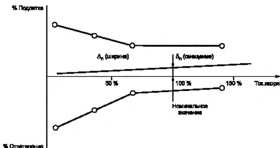
Рисунок 6 — Зона безыскровой коммутации при постоянной скорости вращения
