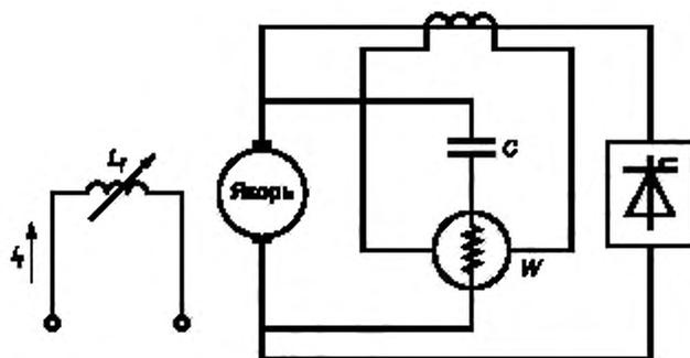
Рисунок 9 — Схема для измерения потерь от пульсирующих токов
