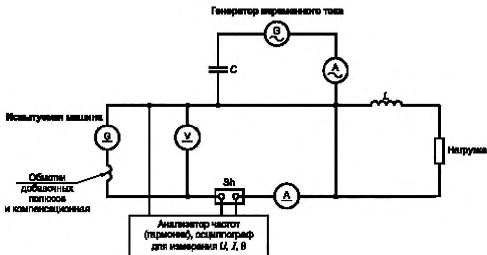
Рисунок 1 — Определение индуктивности цепи якоря с учетом насыщения
