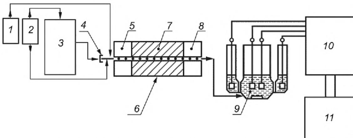
1 — кислород; 2 — аргон (гелий); 3 — блок ввода пробы; 4 — мембрана для ввода образцов;
