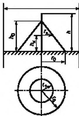
Рисунок А.1 — Зона защиты одиночного стержневого молниеотвода
