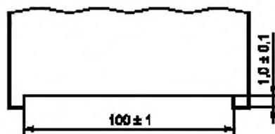
Рисунок 9 — Схема аппликатора для нанесения клея
