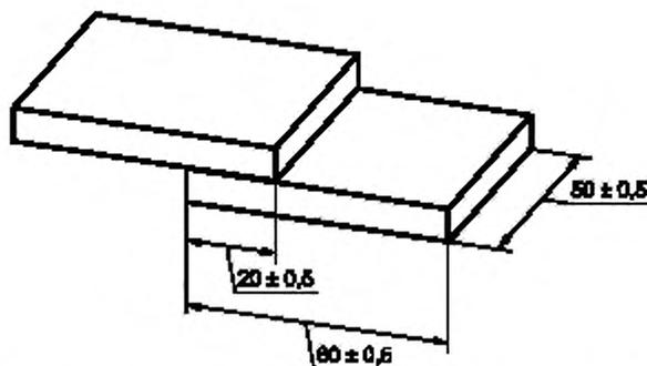
Рисунок 2 — Образец клеевого соединения при испытании на сдвиг
