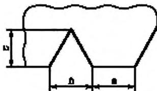
a — ширина зубца; b — расстояние между зубцами; c — глубина выреза
