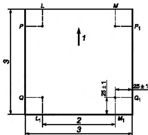
1 — направление материала (продольное направление); 2 — расстояние между болтами 200 мм;
