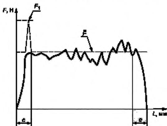
$L$  — длина клеевого соединения, мм;  $F$  — разрушающая нагрузка, Н;  $F_1$  — первое максимальное усилие;  $\bar{F}$  — средняя величина разрушающих усилий;  $c$  — первый и последний участок, равный 10 мм
