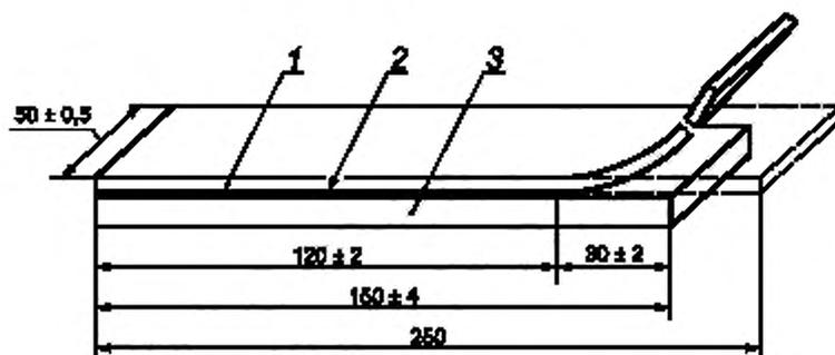
1 — испытываемое покрытие; 2 — клей; 3 — основание
