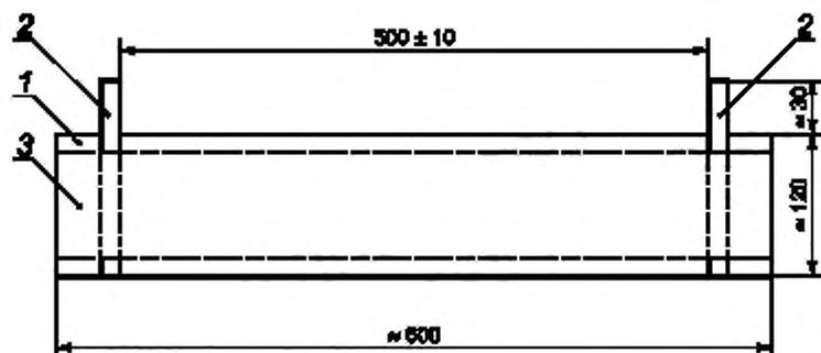
1 — плита стеклянная; 2 — пластина медная; 3 — клеевой слой
