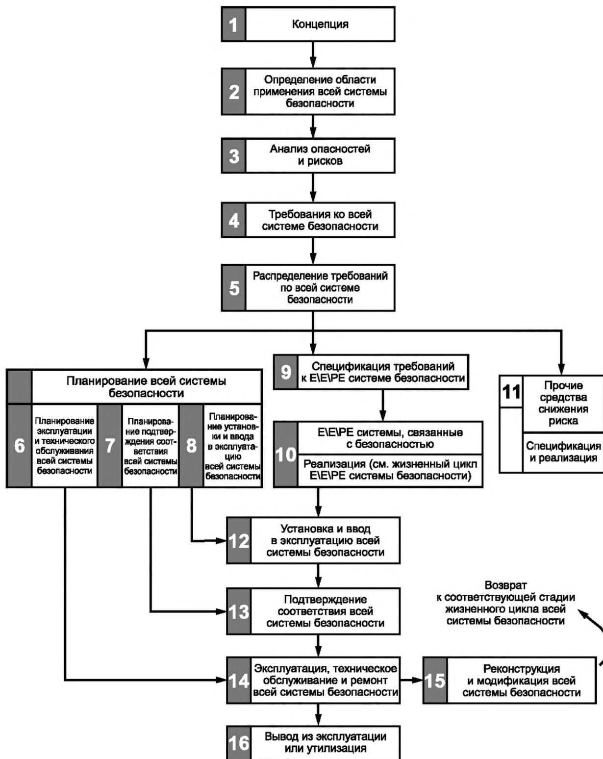
Рисунок 2 — Структура жизненного цикла всей системы безопасности
