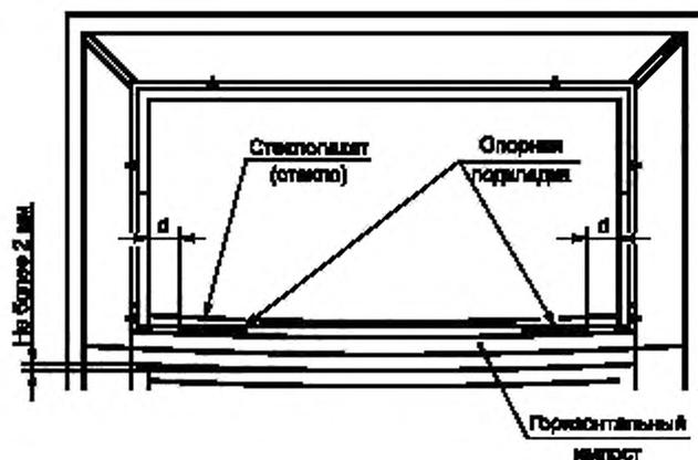
Рисунок Г.8 — Деформации горизонтального профиля
