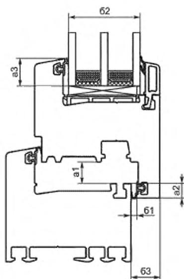
$a_1$  — размер фальцлюфта (зазор в притворе);  $a_2$  — размер притвора под наплавом;  $a_3$  — высота защемления стеклопакета;
