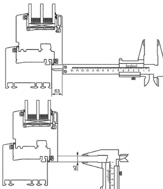
Рисунок Г.6 — Определение величины рабочего наплыва створки
