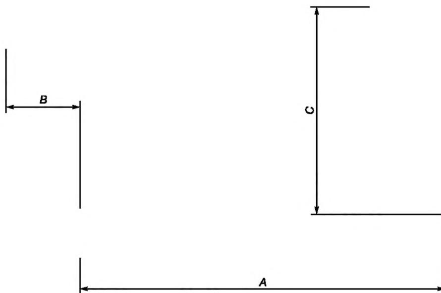
Рисунок Е.1 — Фрагмент размещения защитных элементов. *A* — интервал между элементами в горизонтальном ряду; *B* — смещение рядов защитных элементов по горизонтали относительно друг друга; *C* — расстояние между рядами
