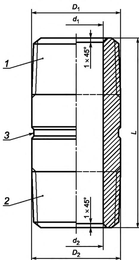
1 — верхний конец; 2 — нижний конец; 3 — маркировочный пояс или участок для нанесения маркировки
