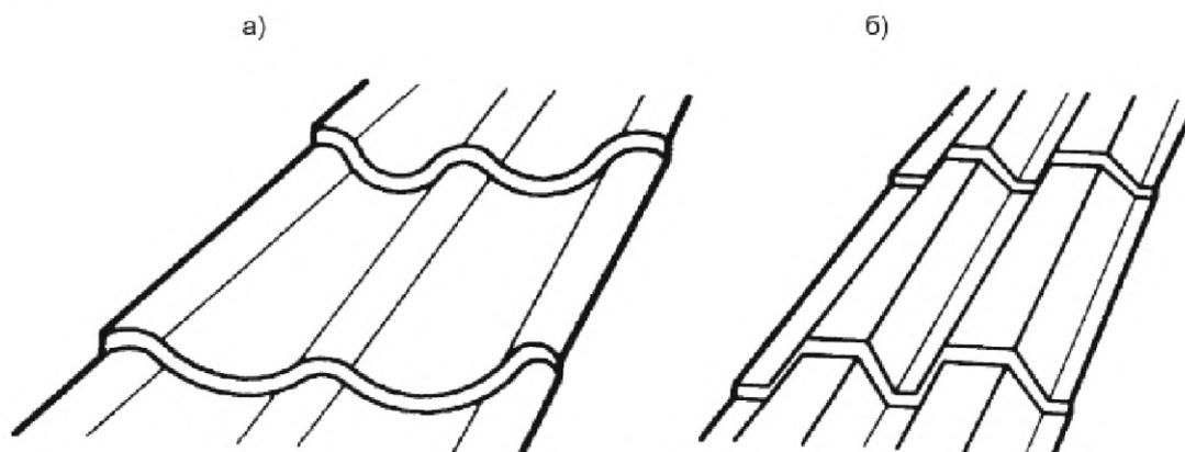
а) — Волнистый профиль; б) — Трапециевидный профиль
