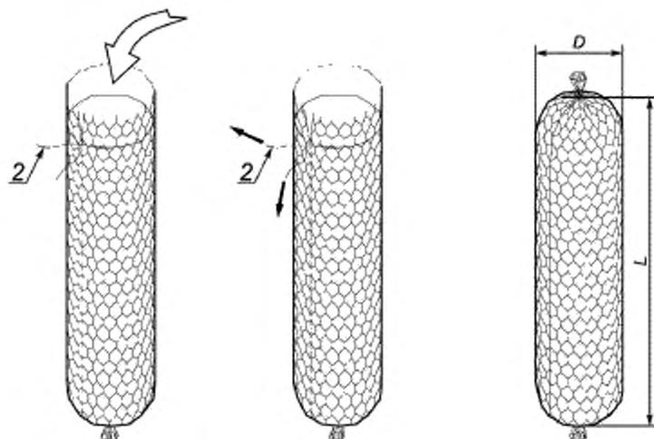
Г — наполнение; 2 — соединяющая проволока; D — диаметр каменного вальца;
