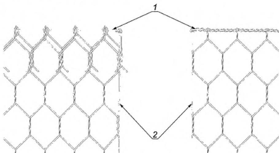
1 — продольная бортовая проволока, 2 — поперечная бортовая проволока
