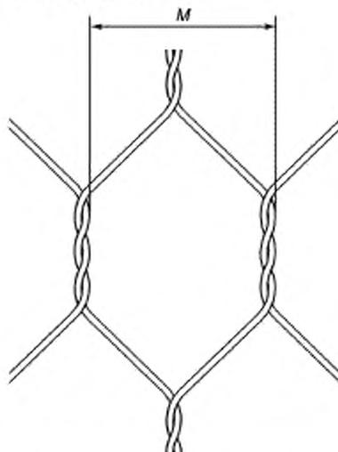
$M$  — рассчитанное среднее значение по измерениям, сделанным между двумя скрученными сторонами 10 ячеек
